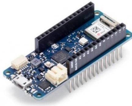
Ilustración 6. Arduino MKR Wifi 1010. Imagen obtenida de BricoGeek.com.
