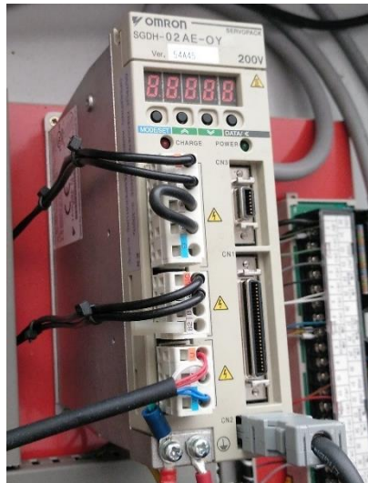
Ilustración 1. Imagen del servopack. Fuente propia. Se muestra el dispositivo a emplear, ubicado en el banco de ensayos montado en el laboratorio.
