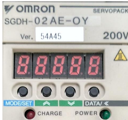
Ilustración 39. Selector de parámetros. Fuente propia. Imagen de la pantalla de cristal líquido y la botonera que permiten variar el valor de los parámetros del servopack.
