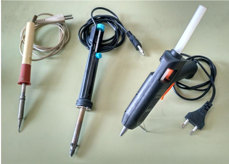
Ilustración 30. Herramientas de soldadura. Fuente propia. Se muestran de izquierda a derecha el soldador, el desoldador y la pistola de cola termofusible empleados en la construcción del prototipo.
