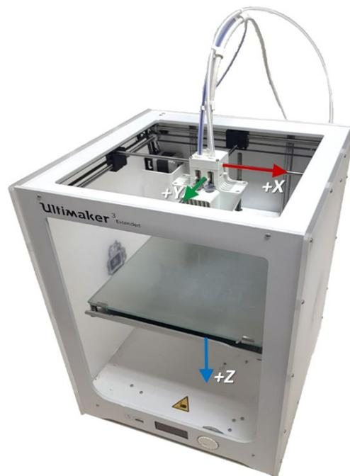
**Figura 6.2.** Representación del sistema de coordenadas de la impresora Ultimaker 3 Extended según normativa ISO/ASTM 52921:2013.
