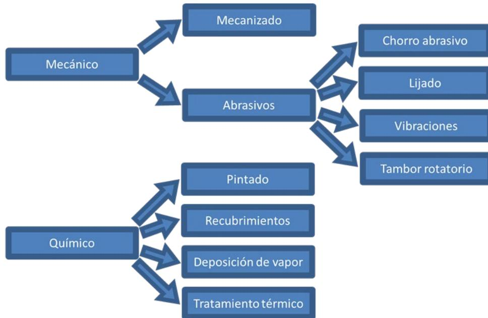
**Figura 2.25.** Diferentes post-procesos aplicables a piezas obtenidas mediante FDM.
