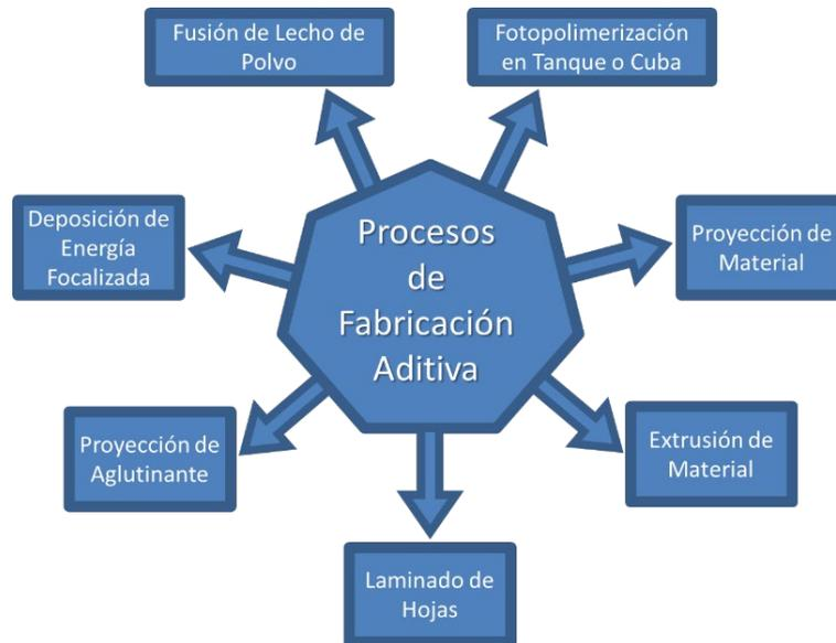
**Figura 2.2.** Procesos de fabricación aditiva según normativa ISO 17296-2:2015.
