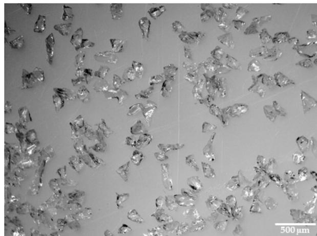
Figura 6.4. Granos de alúmina. Imagen tomada mediante microscopio óptico.
