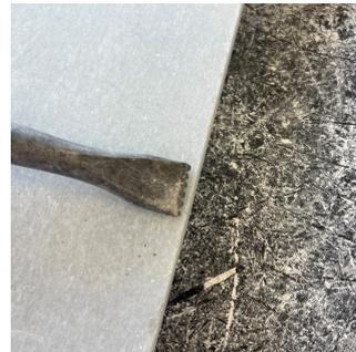
Figura 17: Ángulo de ataque y dirección incorrecta
