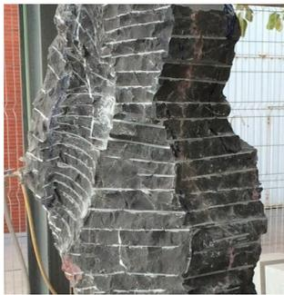
**Figura 5:** Textura resultante del desbaste por paredes
