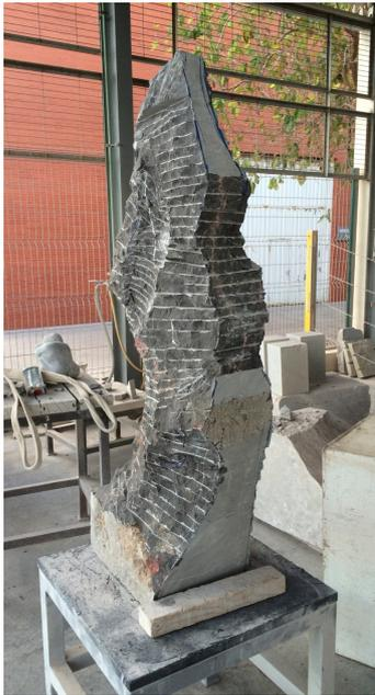
**Figura 18:** Aspecto del desbaste por paredes
