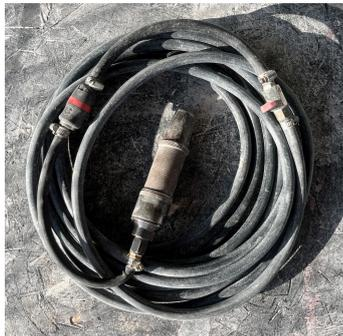
**Figura 3:** Martillo neumático con manguera de aire
