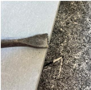
Figura 16: Ángulo de ataque y dirección incorrecta
