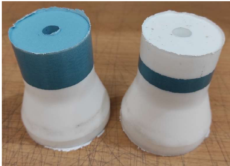
Figura 31. Imagen de la rebaba generada tras el prensado.
