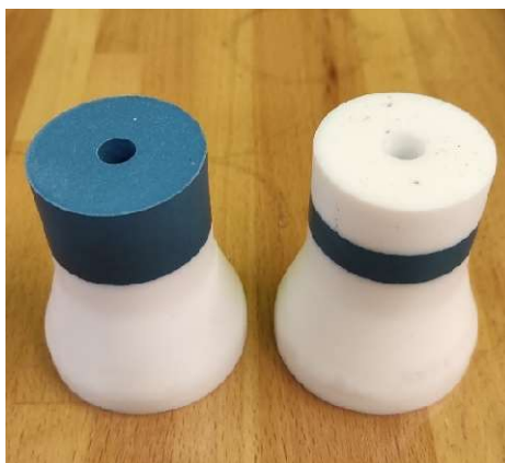
Figura 30. Imagen de las preformas bicomponente sinterizadas.
