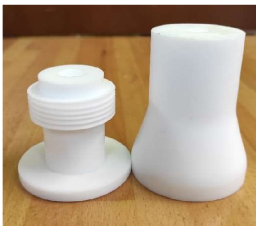
Figura 29. Imagen de la pieza terminada y la preforma sinterizada.
