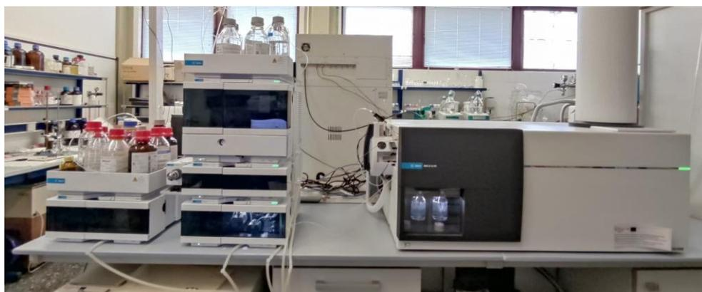
**Figura 3.27.** Imagen del equipo UHPLC-MS-QTOF utilizado durante las mediciones de las muestras obtenidas durante la degradación fotoelectrocatalítica del Imazalil.
