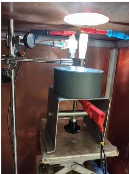
**Figura 3.17.** Montaje de la celda electroquímica utilizada durante los ensayos de rotura de la molécula de agua mediante fotoelectrocatalisis.
