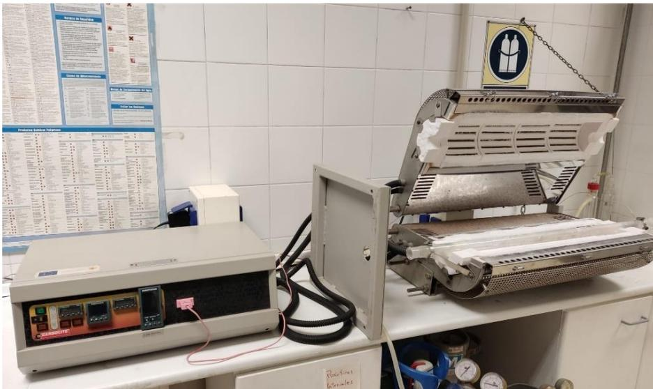
**Figura 3.5.** Horno tubular utilizado durante el tratamiento térmico de las nanoestructuras.
