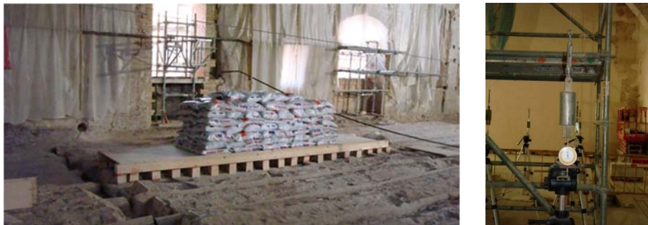
Figura 4. Prueba de carga en el Convento del Carmen (Valencia)
