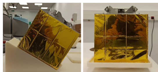
Figura 13: Soportes para ubicar el APM en diferentes orientaciones
