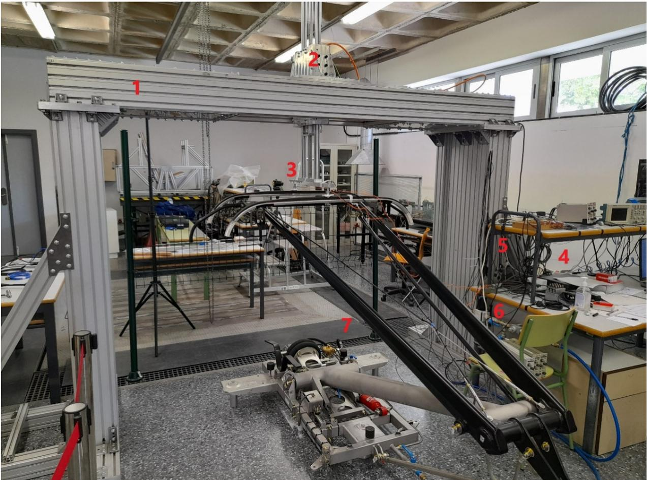
Figura 3. Banco de ensayos con pantógrafo real y catenaria virtual
