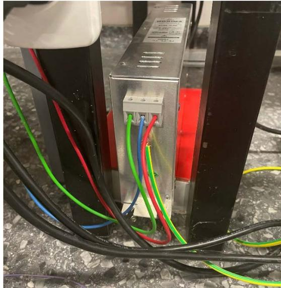
Figura 5. Filtro de red trifásica DLC 3016 del fabricante EMIKON
