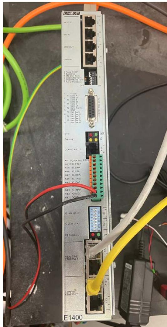
*Figura 8. Vista superior del controlador, puertos de comunicación y alimentación de 24V*
