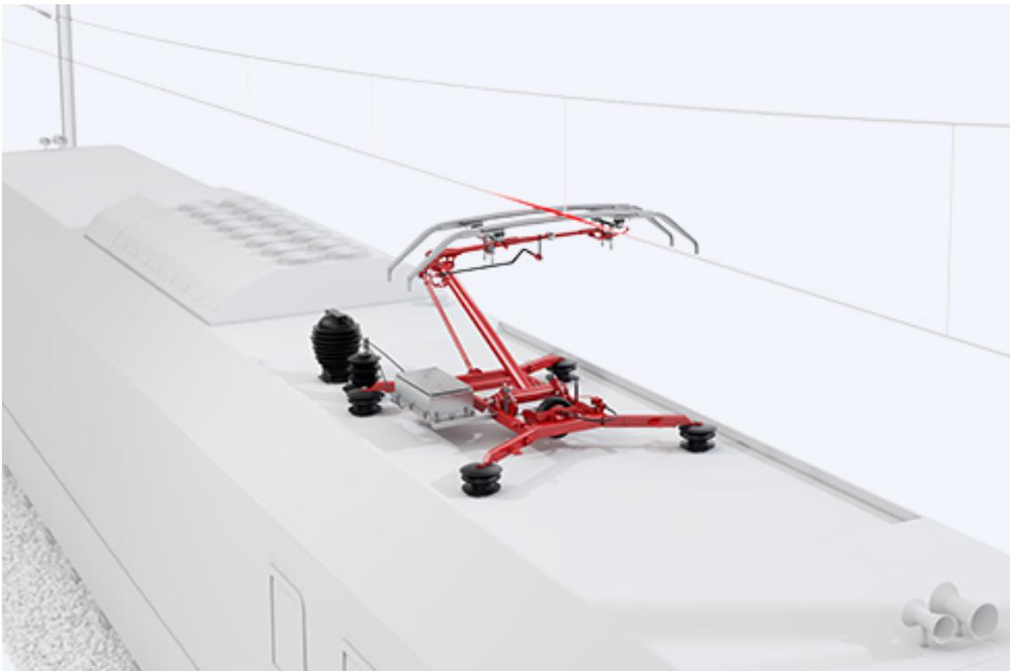
*Figura 1. Imagen de pantógrafo de un tren eléctrico*
