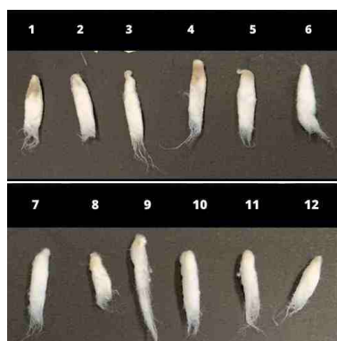
Figura 90. Pruebas de limpieza suciedad. Del 1-5 Agua destilada. Test de Cremonesi: 6: ligroina / 7: LA2 / 8: LA4 / 9: LA5 / 10: LA7 / 11: acetona / 12: etanol.
