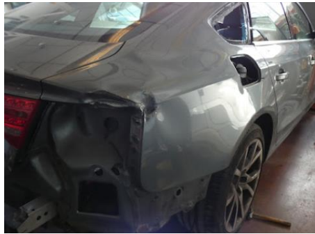
Figura 6. Proceso de reparación de chapa
