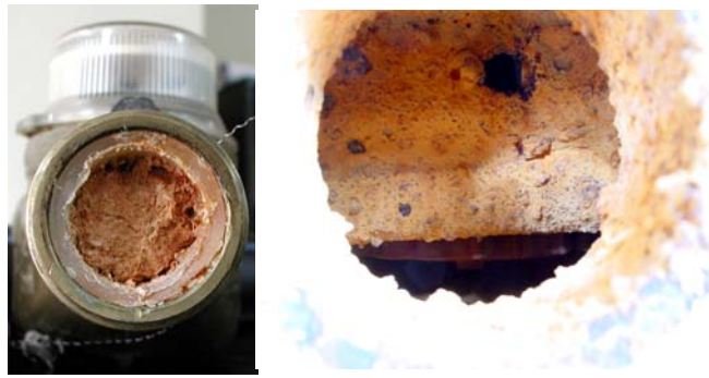
FIGURA 3. DEPOSICIONES CALCÁREAS EN EL INTERIOR DE DOS CONTADORES.
