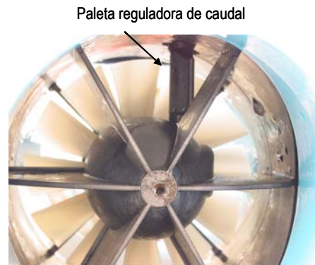
FIGURA 33. PALETA REGULADORA DE CAUDAL EN UN WOLTMAN DE EJE HORIZONTAL.
