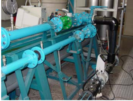
FIGURA 6. VISTA DEL BANCO DE ENSAYO DE VÁLVULAS. CAUDALÍMETRO DE REFERENCIA Y CONTADOR ENSAYADO.
