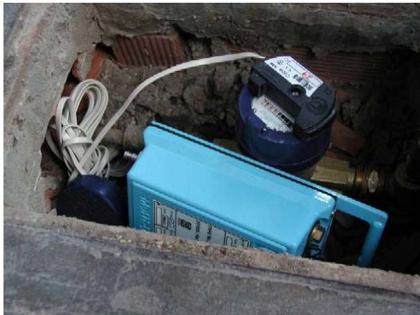
FIGURA 2. EQUIPO DE ADQUISICIÓN DE DATOS PARA LA ESTIMACIÓN DEL PATRÓN DE CONSUMO.
