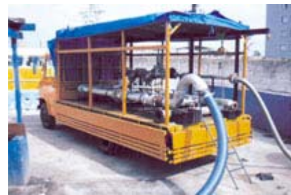
FIGURA 11. CAUDALÍMETRO DE REFERENCIA PORTÁTIL.
