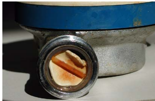
FIGURA 4. INTENTO DE MANIPULACIÓN INFRUCTUOSA: OBTURACIÓN DE LA TOBERA DE SALIDA.
