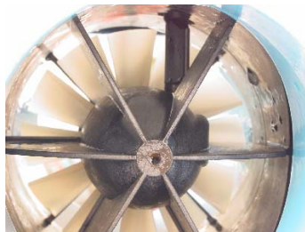
FIGURA 16. DETALLE DE LA PARTE INTERNA DEL CONTADOR WOLTMAN.
