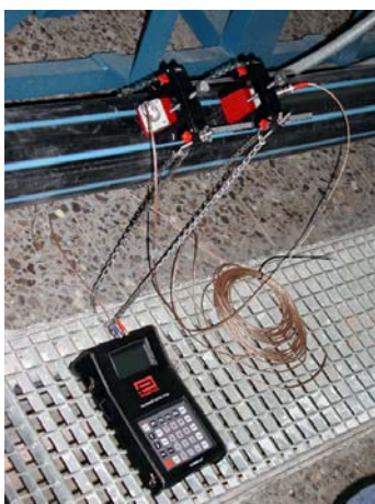
FIGURA 18. CAUDALÍMETRO DE ULTRASONIDOS DE TIEMPO DE TRÁNSITO PORTÁTIL.
