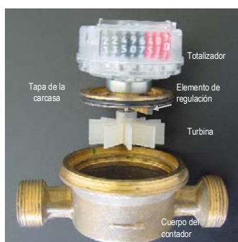
FIGURA 6. DESPIECE DE UN CONTADOR DE CHORRO ÚNICO.
