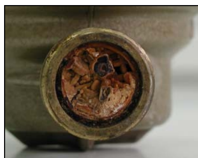
FIGURA 6. FILTRO DE ENTRADA OBSTRUIDO.
