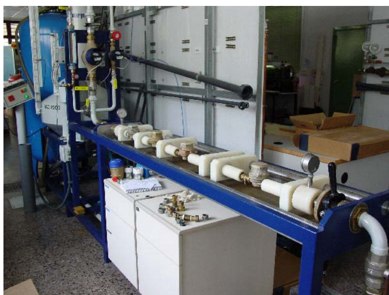
FIGURA 1. VISTA GENERAL DEL BANCO DE ENSAYO DE CONTADORES DE PEQUEÑO CALIBRE (<40MM).
