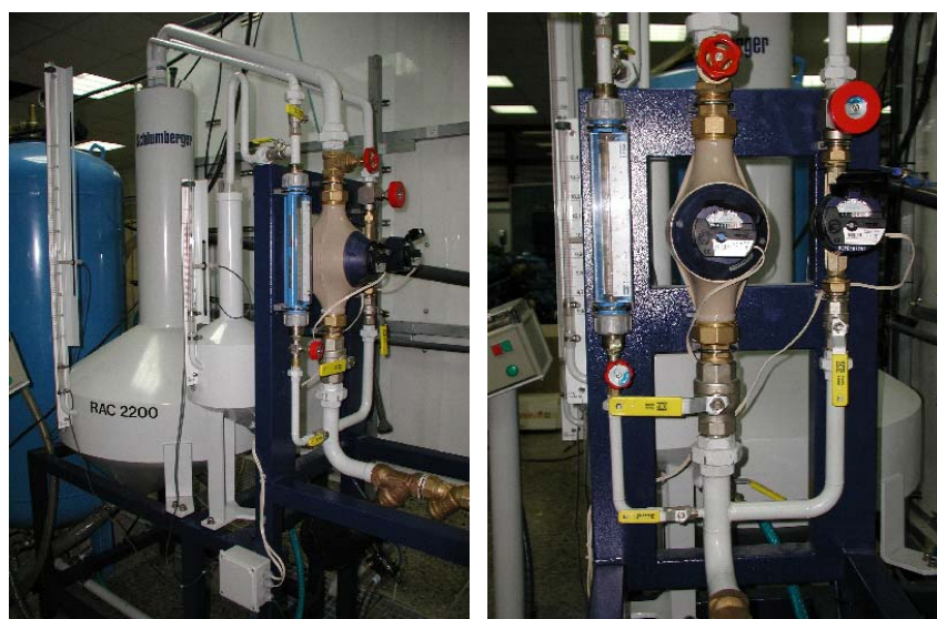
FIGURA 1. VISTA GENERAL DEL BANCO DE ENSAYO DE CONTADORES DE PEQUEÑO CALIBRE (<40MM).
