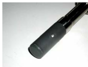
FIGURA 24. SONDA DE INSERCIÓN ELECTROMAGNÉTICA.
