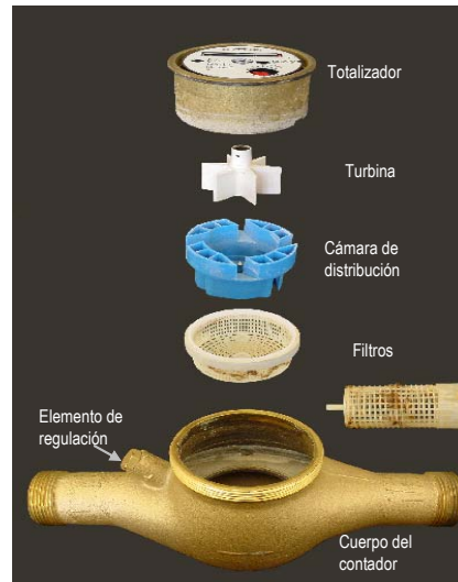
FIGURA 9. DESPIECE DE UN CONTADOR DE CHORRO MÚLTIPLE.
