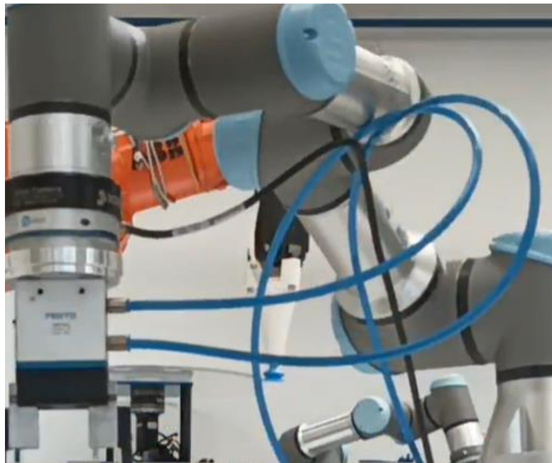
Fig 85: Sujeción de los cables
