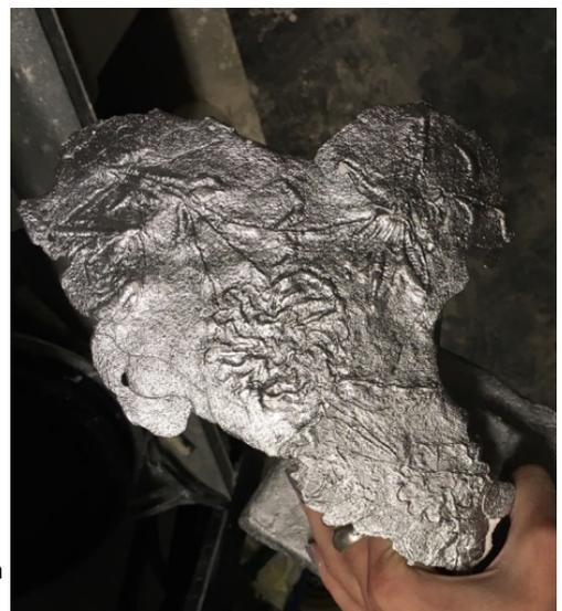
Fig. 14. Pieza ya en aluminio, fuera del revestimiento cerámico.
