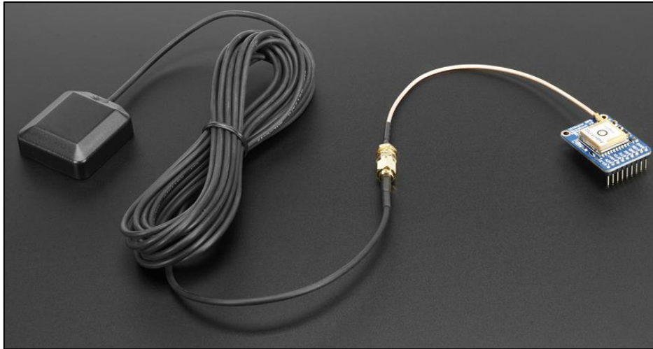
Imagen 26 - Montaje del sistema GPS con la antena exterior, el cable SMA a uFL y el módulo GPS
