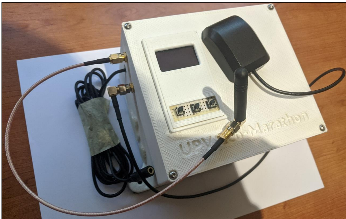
Imagen 60 - Montaje final con las antenas GPS y GSM conectadas
