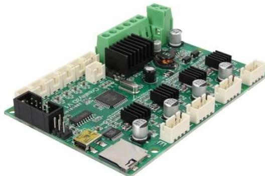
Figura 69: Placa base de la impresora 3D.[97]
