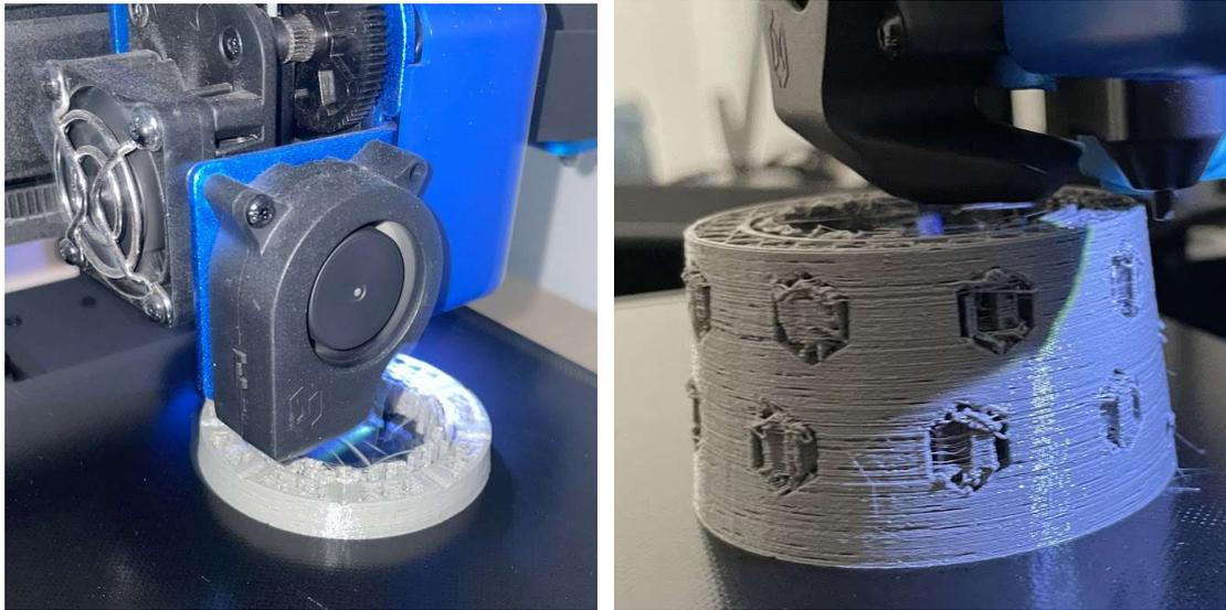
Figura 212: Imágenes del proceso de impresión de la pieza 1.1 a escala 1:2. Elaboración propia.
