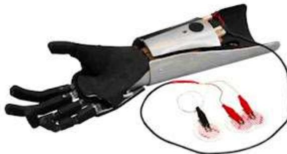
*Figura 23: Prótesis mioeléctrica accionada externamente [75]*
