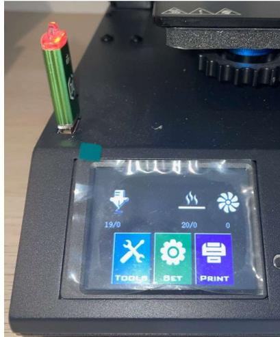
*Figura 83: Colocación del USB. Elaboración propia.*
