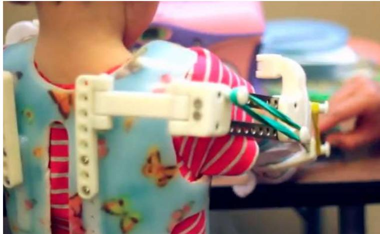
*Figura 4: Exoesqueleto en impresión 3D [54]*
