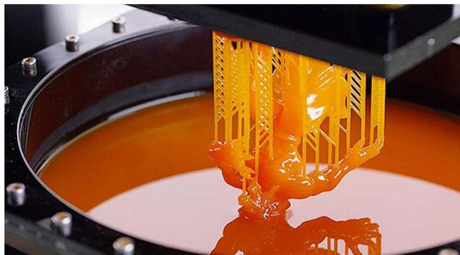
*Figura 28: Proceso de fotopolimerización [80]*
