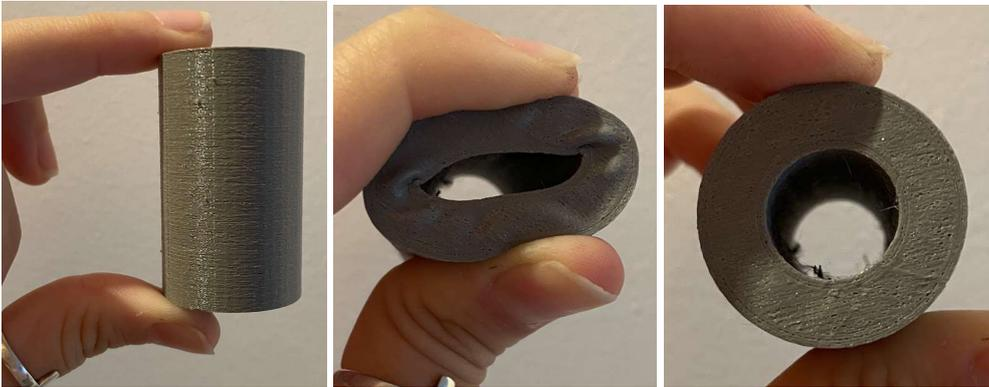
Figura 189: Imágenes de la impresión cilíndrica con un 20% de relleno
