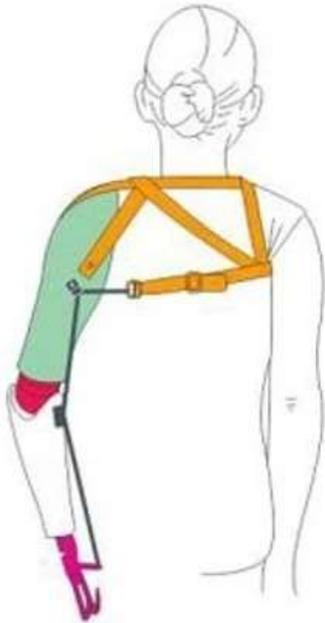
*Figura 22: Prótesis accionada por el cuerpo [74]*
