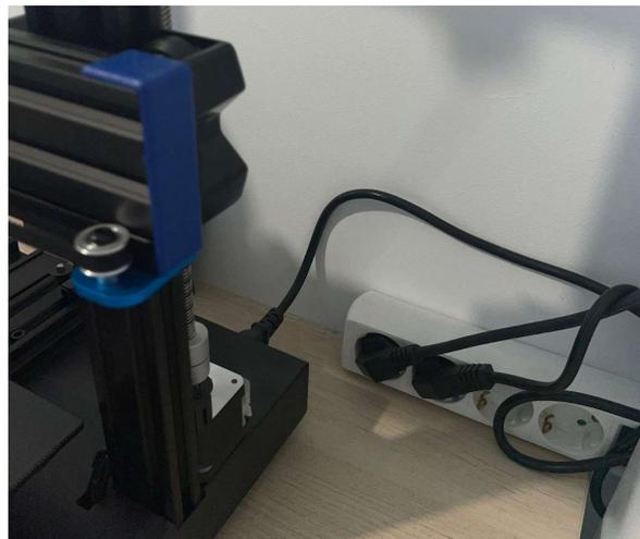
Figura 82: Fuente de alimentación de la impresora. Elaboración propia.
