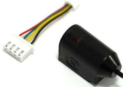
Figura 71: Sensor inductivo de la impresora 3D.[100]
