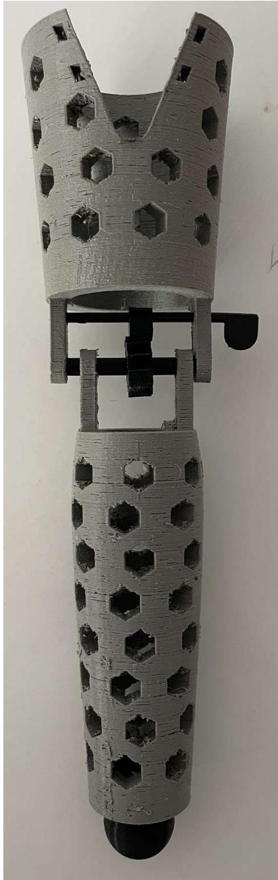
*Figura 218: Prototipo de la prótesis a escala 1:2. Elaboración propia.*
