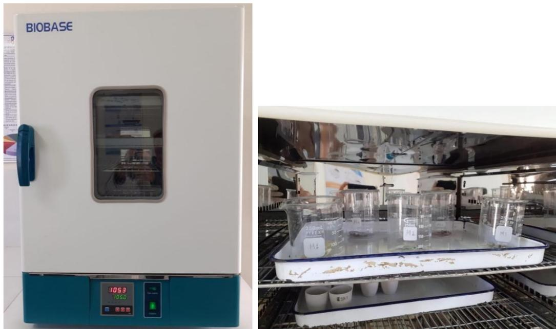
Secado muestras en horno a temperatura de  $110^{\circ}\text{C} \pm 5^{\circ}\text{C}$  hasta una masa constante
