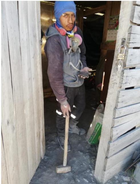
Las herramientas utilizadas durante la extracción de la piedra de la mina son: puntas para hacer los huecos en la hebra de la piedra e insertar las cuñas con los combos o mazos posteriormente a los combos pequeños y grandes, se añade una barra para partir la piedra en fragmentos manejables y para su movilización, como se observa en las figuras 13 y 14.
