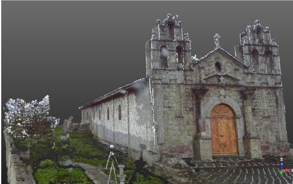
Nota: Nube de puntos a color de la perspectiva de la Iglesia Sicalpa Viejo, levantada con escáner FARO Focus Láser 3D y depurada con programa software Trimble Real Works.
