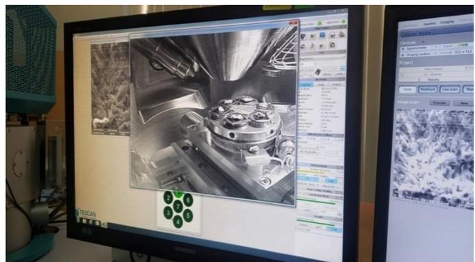
Interior del microscopio electrónico de barrido (VEGA3 SEM-EDX Tescam Company Alemania).
