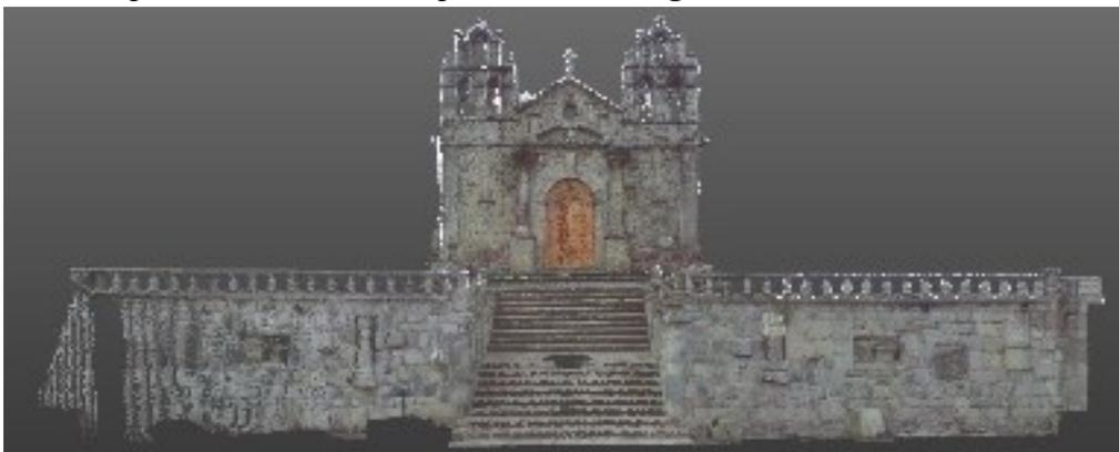
*Nota:* Figura Nro. 36-4: Nube de puntos de las portadas de la Iglesia Sicalpa Viejo, levantada con escáner FARO Focus Láser 3D y depurada con programa software Trimble Real Works.
