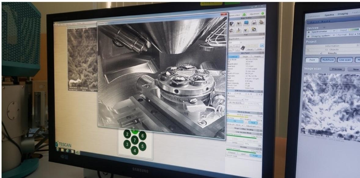
Interior de microscopio electrónico de barrido (VEGA3 SEM-EDX Tescam Company Alemania Fuente: Elaboración propia (2022).
