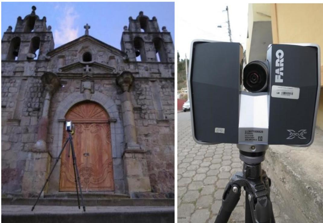
*Nota:* en el proceso de levantamiento e información, se observa la fachada de la iglesia Nuestra Señora de las Nieves de Sicalpa Viejo y equipo escáner FARO Focus Láser 3D.
