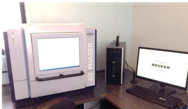
Difractómetro de rayos X marca: Bruker, modelo: D2PHASER
