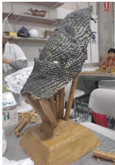
Fig. 27. Sara González: colocación de bebederos de la pieza superior.
