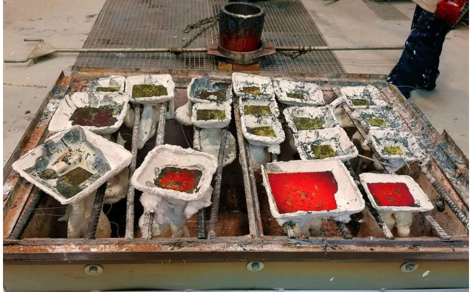
Img. 30. Lecho de colada con las cascarillas tras el vertido de metal en tiempo de solidificación.
