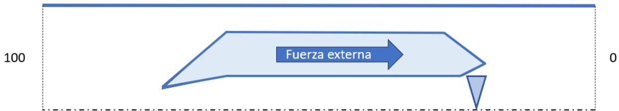
Figura 5.4: Volumen de control del pod y balance de fuerzas
