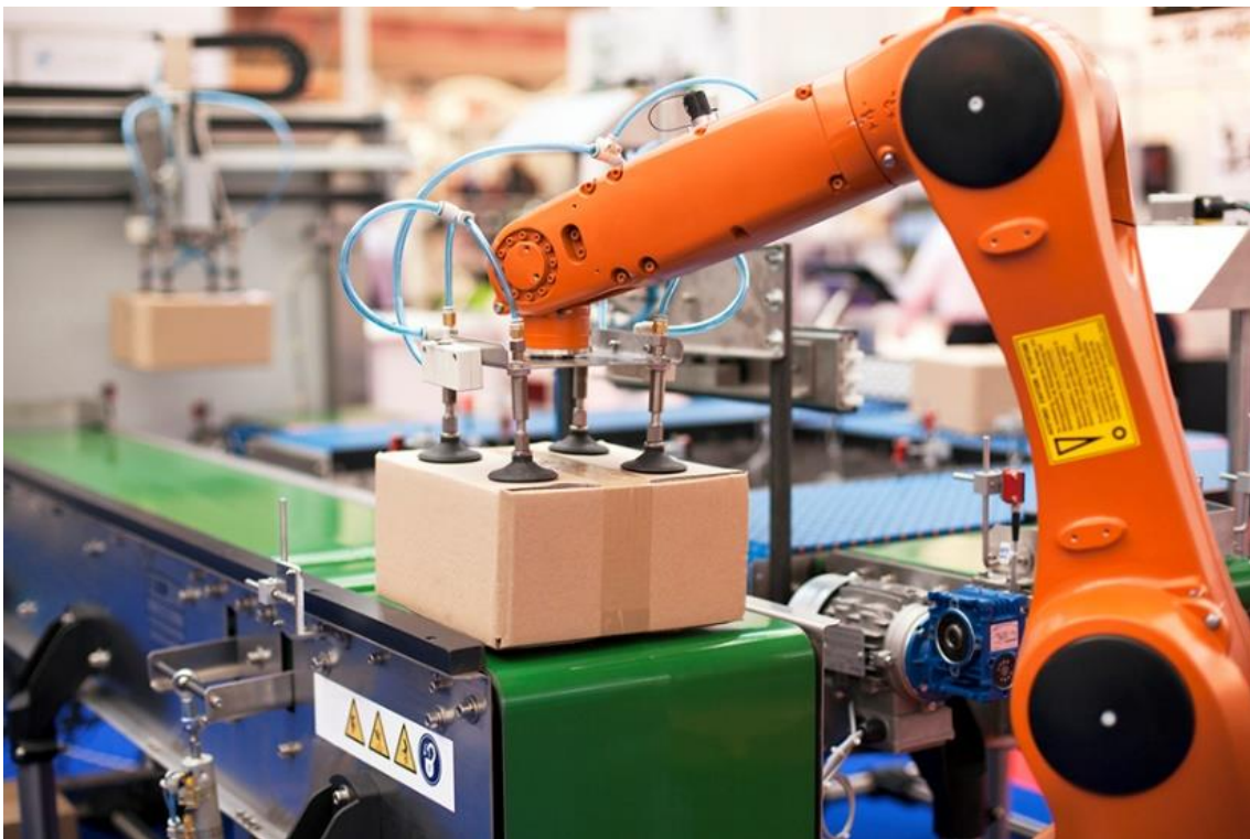
Figura 2.3 Robot Manipulador con herramienta ventosa
