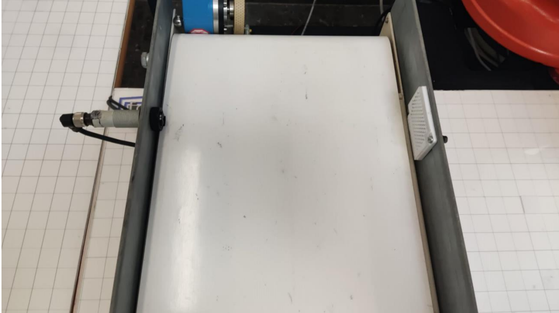
Figura 5.14 Cinta transportadora con Sensor Fotoeléctrico
