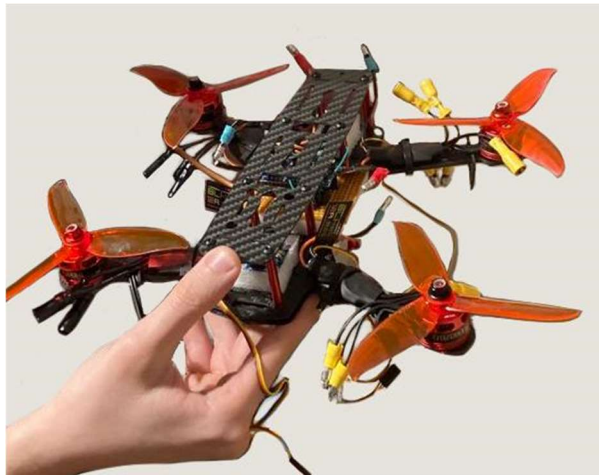
Figura 24: Paso 12, inclusión de las hélices.
