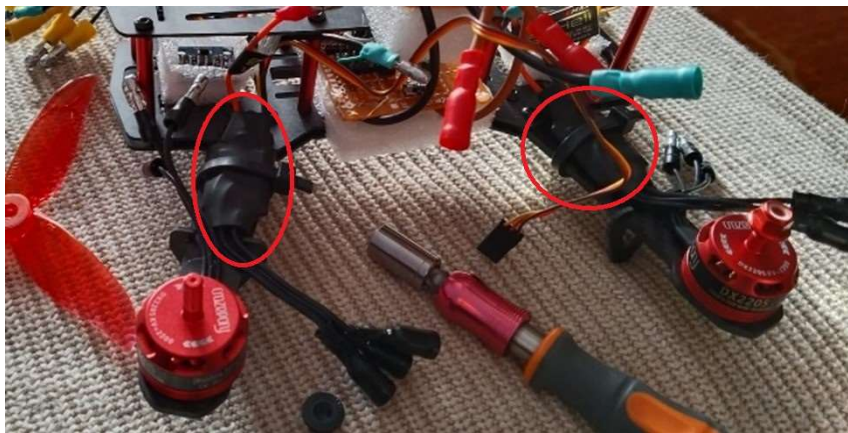
Figura 23: Paso 9, ESCs en la aeronave.
