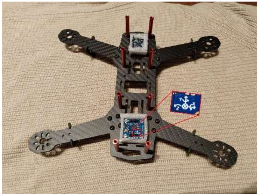
Figura 19: Paso 6, inclusión de IMU y giroscopio.
