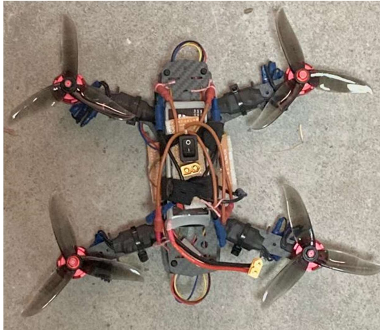
Figura 25: Paso 14, resultado final del montaje.
