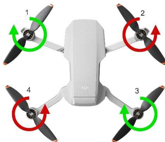
Figura 21: Paso 8, sentido de giro de los motores.
