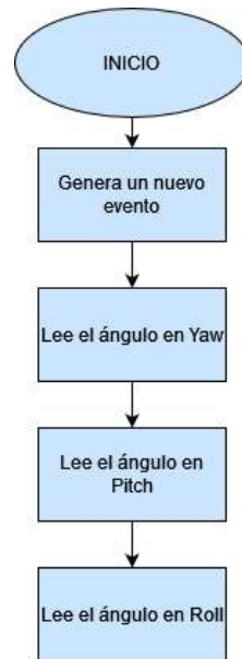
Figura 56: Diagrama de flujo de la función IMU_read_abspos() .
