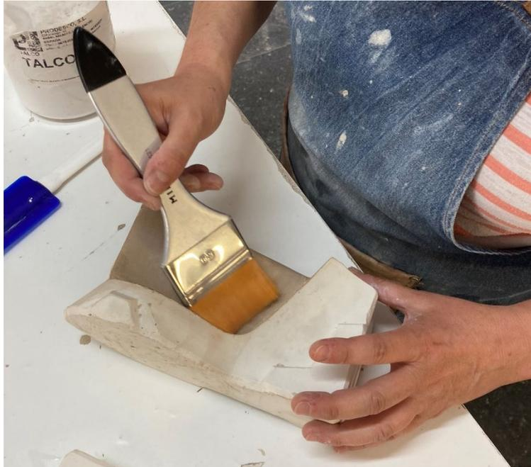
*Imagen 6: Aplicación de talco sobre el molde. Fuente: Elaboración propia.*
