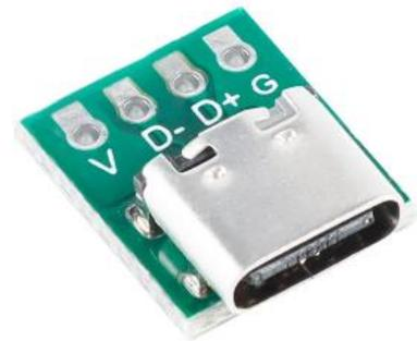
Figura 56 Adaptador Cable tipo C
