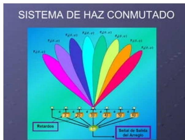
Figura 4. Sistema de seguimiento por haz conmutativo
