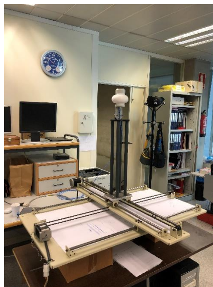
Figura 4.3. Sonda y antena en Rx. Vista anterior. Fuente: Cristina Catalá, TFM, [13].
