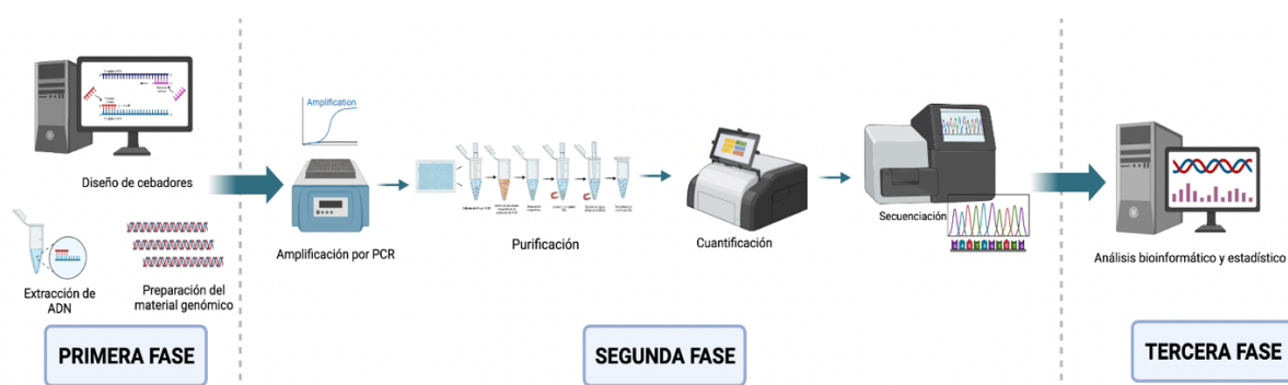
Figura 4. Diagrama del diseño experimental llevado a cabo para el proceso de optimización. Elaborado mediante Biorender.
