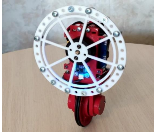
Figura 6. Robot unicycle con volante de inercia
