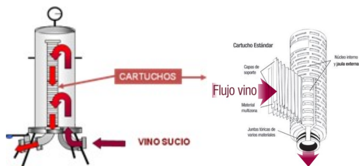
Figura 5. Flujo de vino dentro filtro de membranas (diseño propio) y en el cartucho de filtración. (3M IBERIA, 2011)
