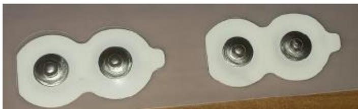
[Figura 14](#). Imagen de dos duoelectrodos utilizados durante la adquisición ([Moya, 2021](#))
