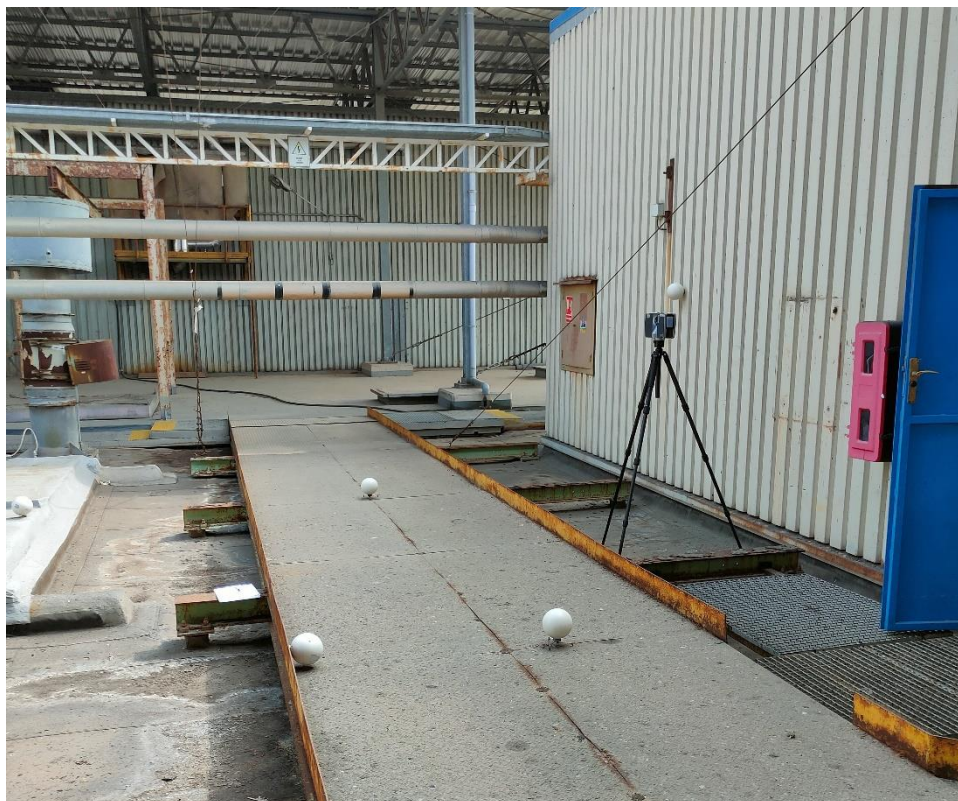
Ilustración 27. Distribución de esferas en un escaneo. Ilustración Propia
