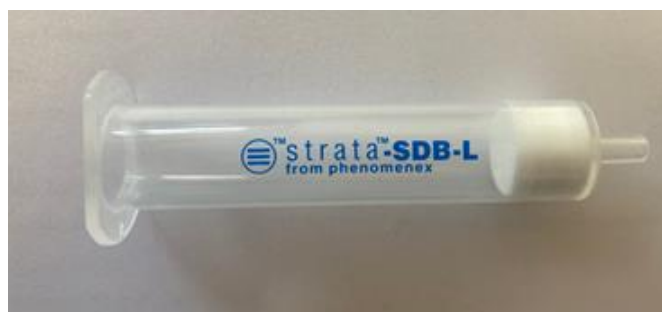
Figura 7. Cartucho empleado en el proceso de extracción en fase sólida para la extracción de los fenoxiácidos de las matrices acuosas. Fuente: elaboración propia.
