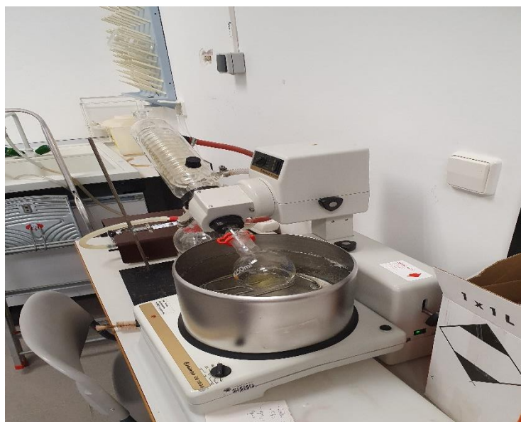
Figura 12. Equipo de rotavapor empleado para evaporación a sequedad de la fracción líquida obtenida tras el tratamiento de la muestra de suelo. Fuente: elaboración propia.
