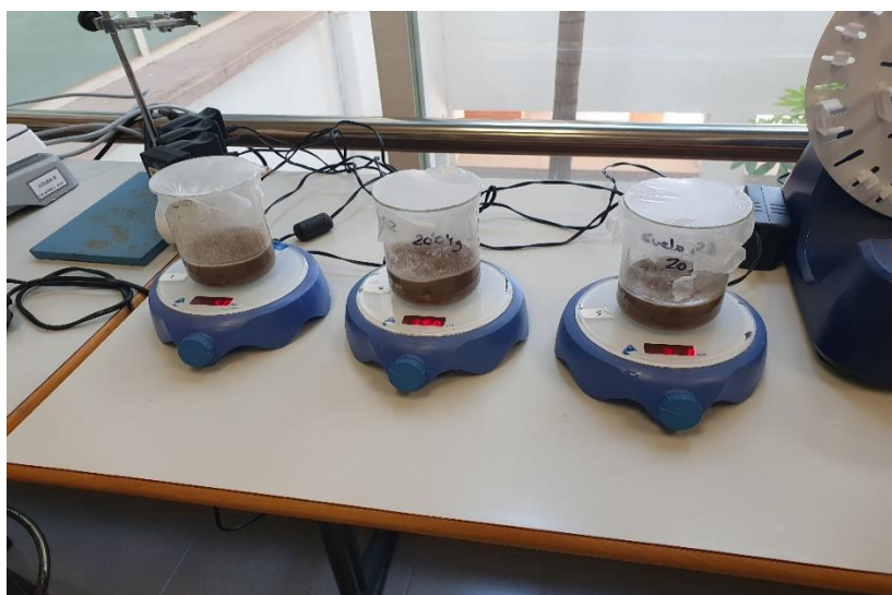
Figura 10. Agitación del suelo en contacto con el metanol-agua (1:1, v/v). Fuente: elaboración propia.
