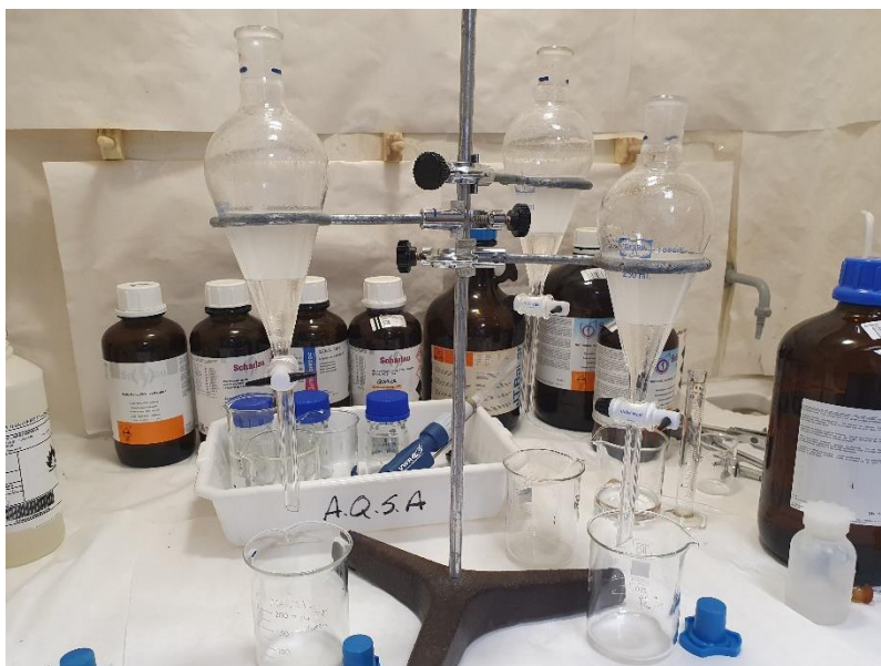
Figura 11. Reparto del filtrado de suelo con diclorometano. Fuente: elaboración propia.
