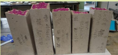
Figura 21. Ensayo de carbonata-
