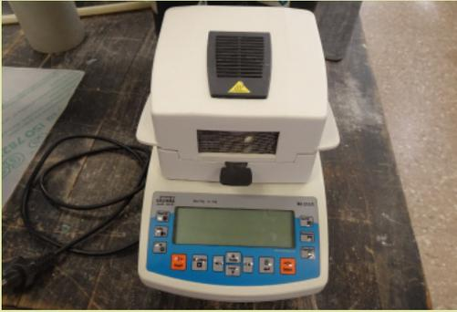
Figura 4. Análisis del contenido de humedad de arena. Elaboración propia.
