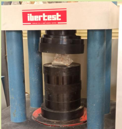
Figura 6. Rotura probetas con la prensa. Elaboración propia.
