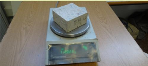
Esto se mantuvo durante 24 horas y tras este periodo, se extrajeron las probetas, determinando el peso hidrostático y el peso saturado.
