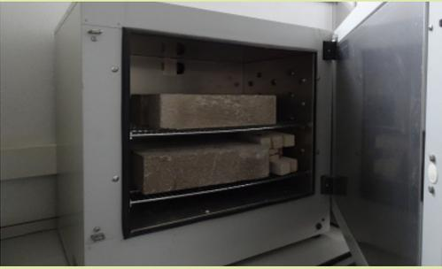
El análisis de la resistencia a la carbonatación del hormi-
