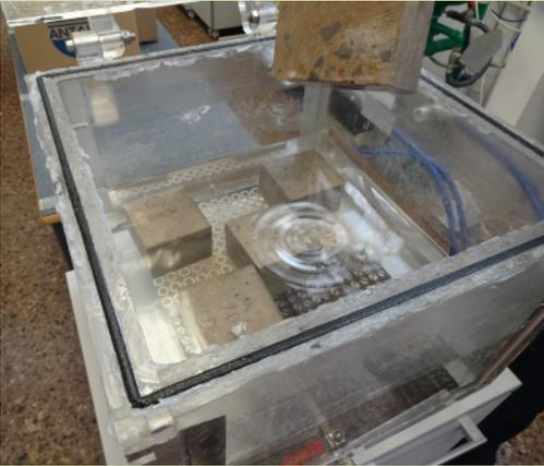
Figura 24. Ensayo de carbonatación. Elaboración propia.
