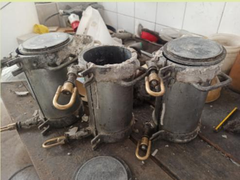
Figura 13. Desmoldado probetas.
