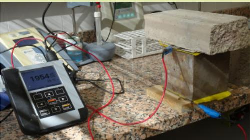
Figura 25. Ensayo de carbonatación.
