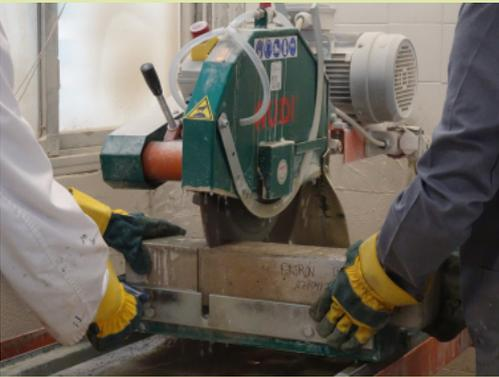
Se realizan ensayos mecánicos de resistencia a compresión en ambas fases de hormigonado, la fase 1 consiste en dos hormigones de relación agua/cemento 0'6 y 0'8. La fase 2 consiste en triturar el hormigón de la fase 1 y añadirlo en un porcentaje variable del 20% y del 40%.
