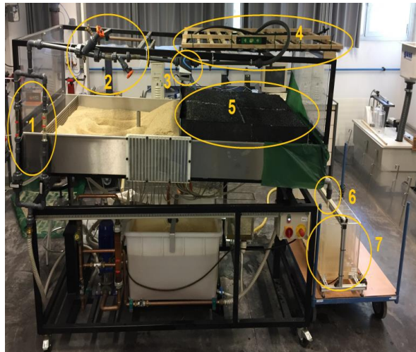
Figura 1 | Banco hidrológico modificado: (1) rotámetros, (2) válvulas (3) contador (4) parrilla de goteros (5) recipiente para material ensayado (6) salida (7) cubeta de hidrogramas
