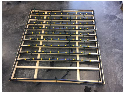
(d) Rain simulator construction.
