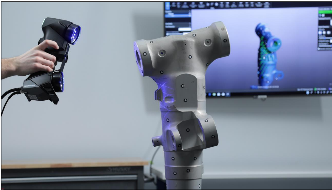
Ilustración 4. Ejemplo de uso de un escáner de luz estructurada. Fuente: CreaForm
