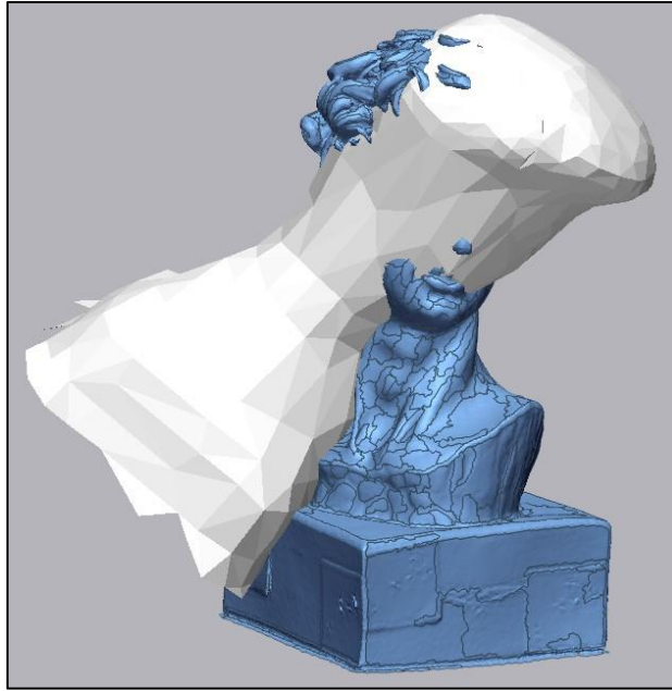
Ilustración 24: Alineamiento inicial erróneo por la falta de correspondencia geométrica entre modelos. Fuente: Propia.
