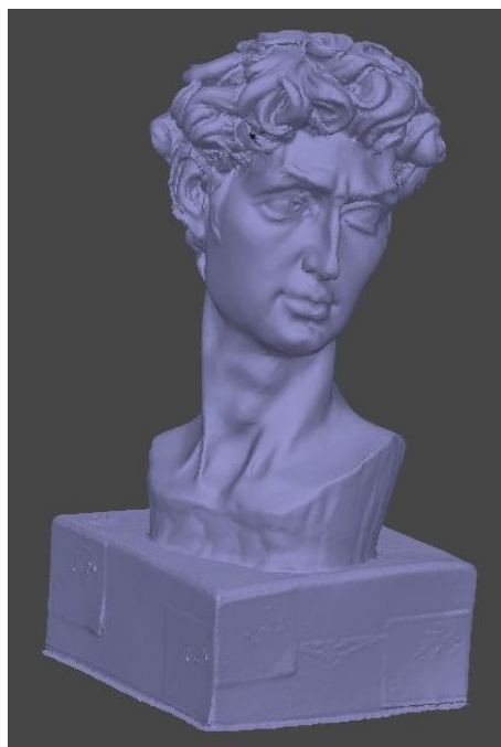
Ilustración 23: Modelo de referencia obtenido con el escáner de luz estructurada. Fuente: Propia.
