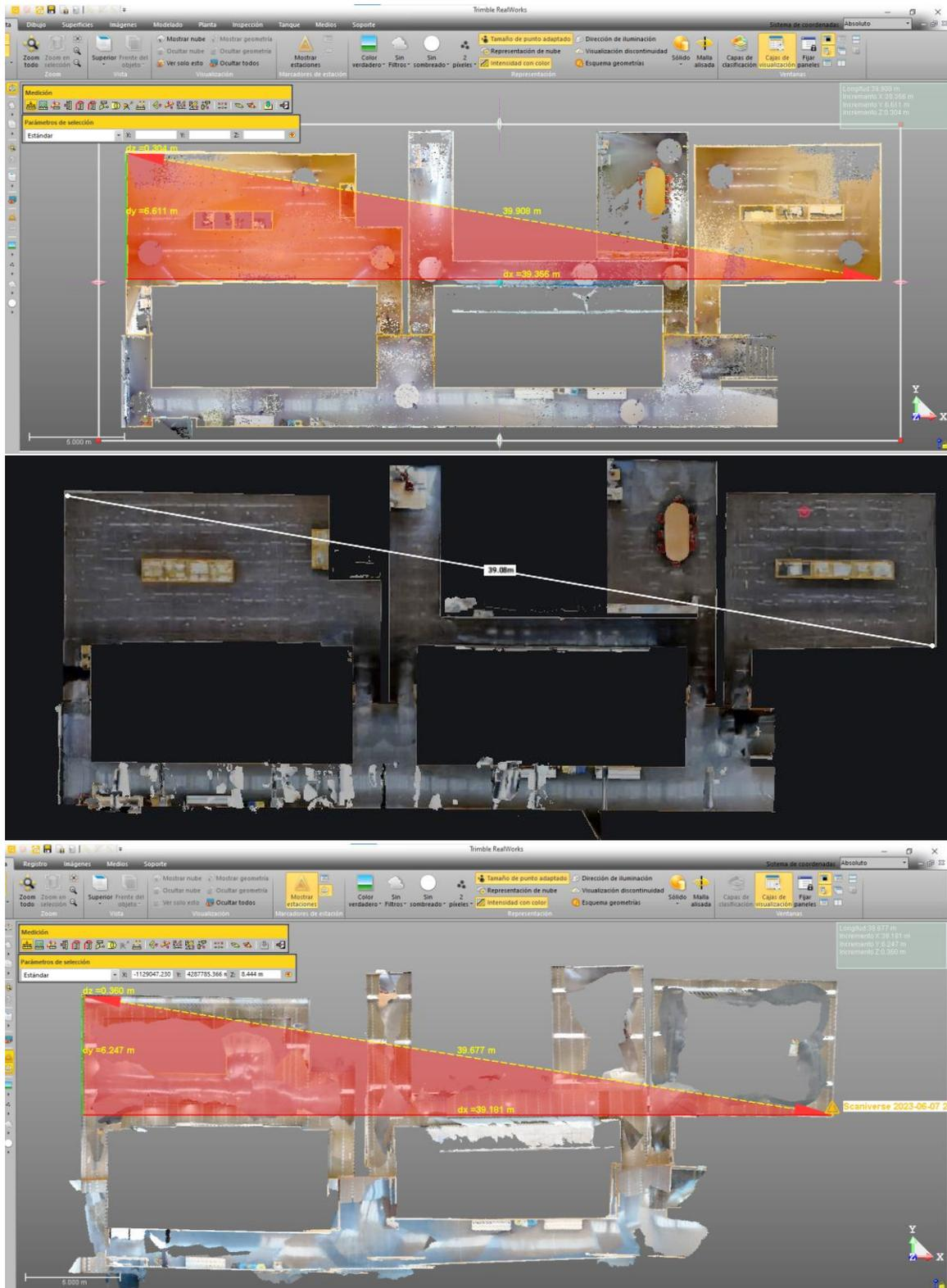
Ilustración 23 - Comparativa: arriba láser escáner, en el centro fotogrametría y abajo Lidar
