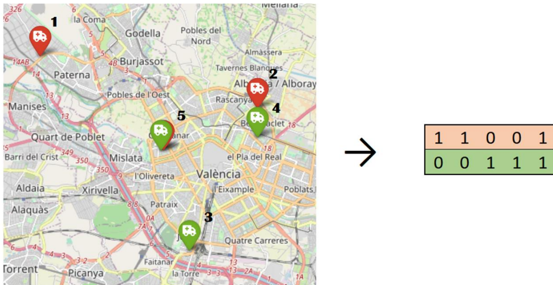
Ilustración 18. Transformación de la posición natural de las ambulancias a la representación matricial. Elaboración propia con Python (folium), y Excel.
