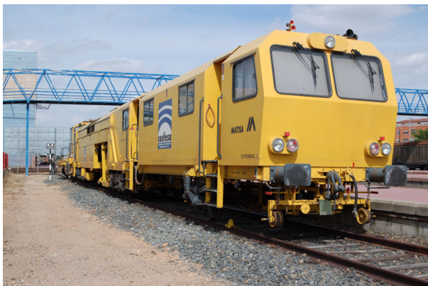
Figura 62: Bateadora MATISA, propiedad de la Cosfesa, en la estación de ferrocarril de Salamanca. Fuente: Dominio público.
