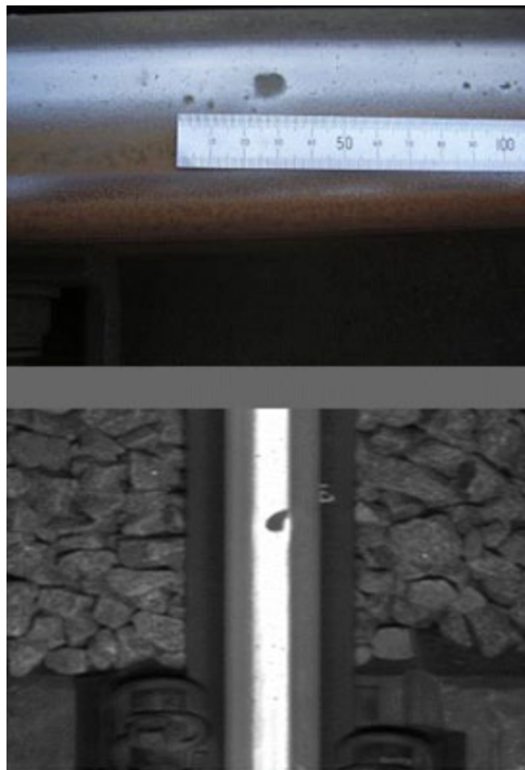
Figura 6: Daño en superficie de rodadura debido a ballast pitting en Eurotúnel. Fuente: [3]
