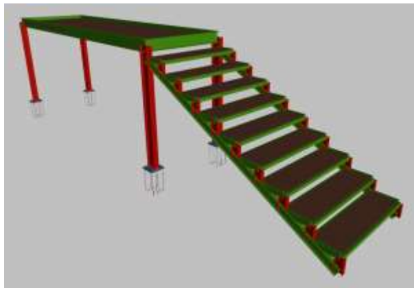
Figura 15. Pasarela de mantenimiento. Alternativa 1 y Alternativa 2.
