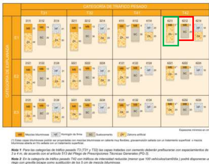
FIGURA 2.2. CATÁLOGO DE SECCIONES DE FIRME PARA LAS CATEGORÍAS DE TRÁFICO PESADO T3 (T31 y T32) y T4 (T41 y T42), EN FUNCIÓN DE LA CATEGORÍA DE EXPLANADA
