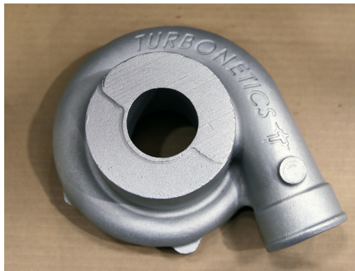
Figura 16: Colector de un turbogrupo.
