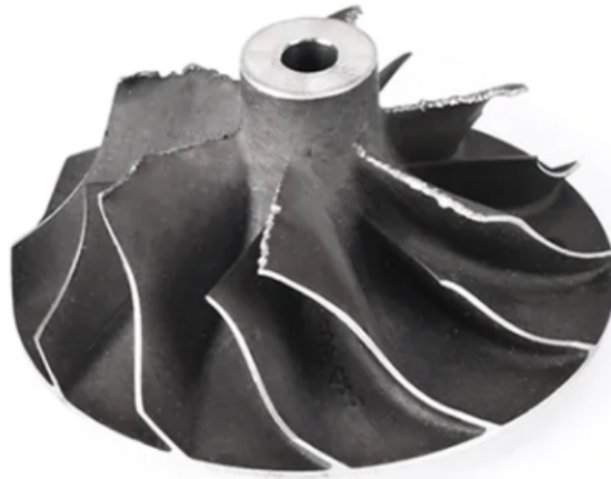
Figura 31: Daño en compresor causado por impacto con objetos extraños [46].
