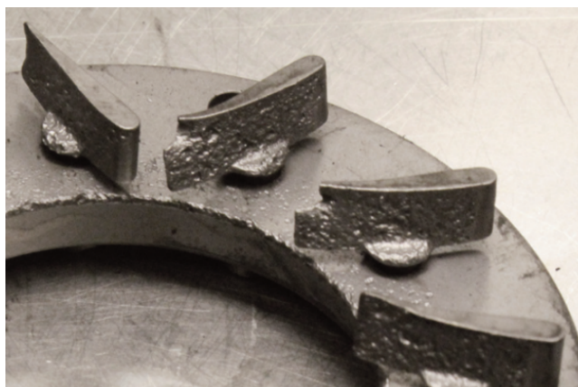
Figura 30: Daño en los álabes de la TGV [46].
