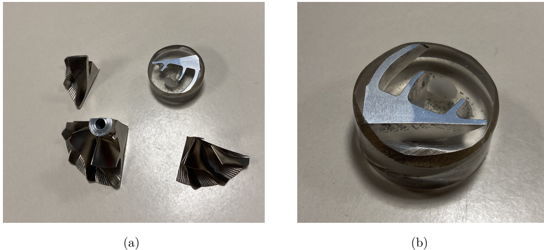
Figura 38: a) Piezas obtenidas tras cortar el compresor y b) Parte del compresor de interés cortada y embutida.
