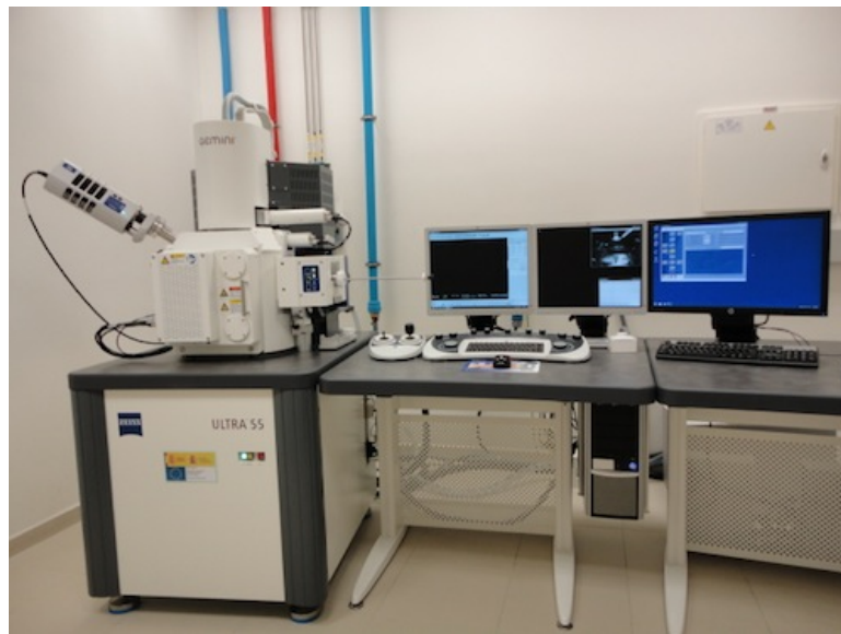
Figura 42: Equipo empleado en FESEM [52].
