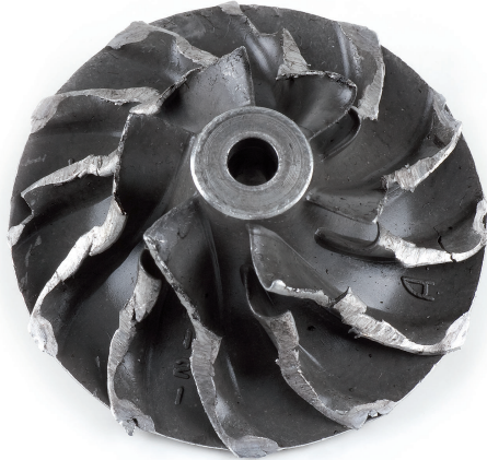
Figura 28: Daño en compresor causado por impacto con carcasa [45].
