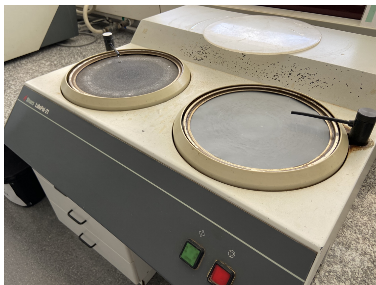
Figura 39: Desbastadora de laboratorio empleada.
