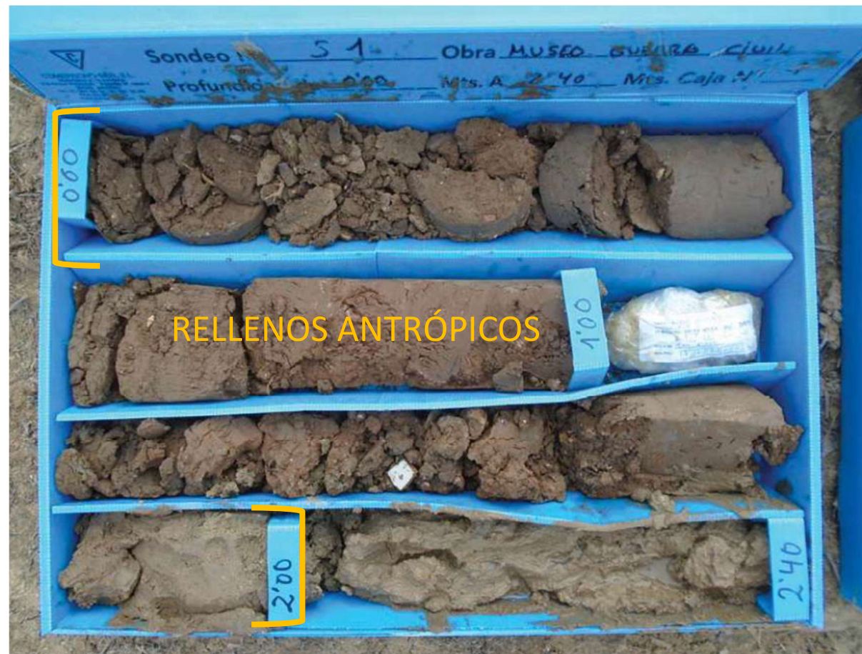
Figura 11. Caja portatestigos. Material a profundidad 0.00 – 2.40 m del S-1 (Fuente: Estudio geotécnico)
