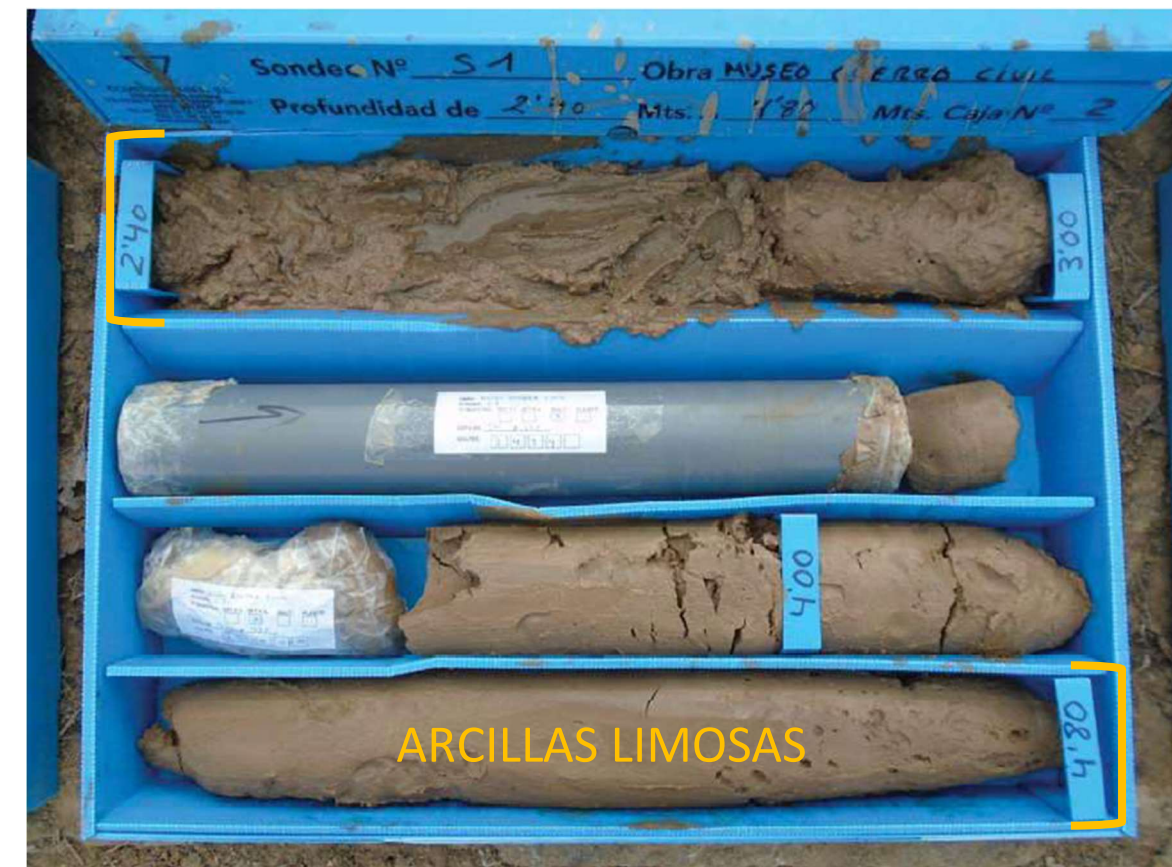
Figura 12. Caja portatestigos. Material a profundidad 2.40 – 4.80 m del S-1 (Fuente: Estudio geotécnico)
