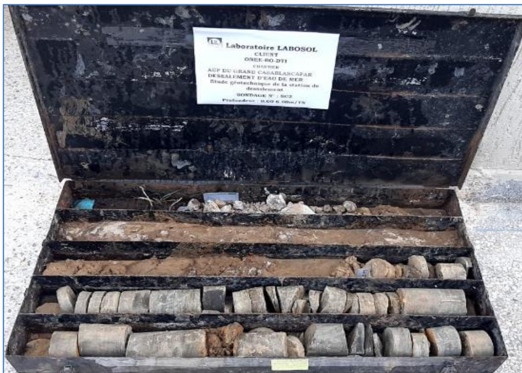
Photo N°10 : Montrant les matériaux extraits du sondage carotté SC2 du 0.00 à 6.00m/TN
