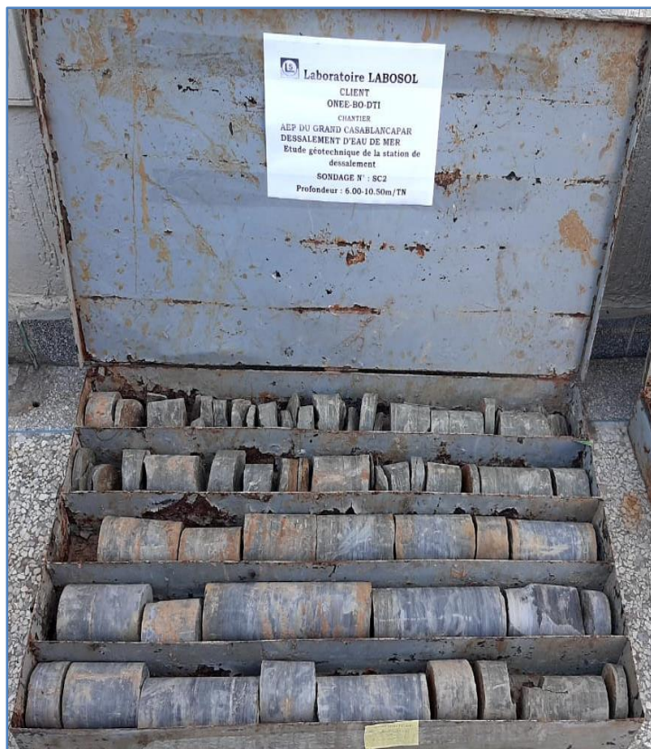
Photos N°11 : Montrant les matériaux extraient du sondage carotté SC2 du 6.00 à 15.00m/TN
