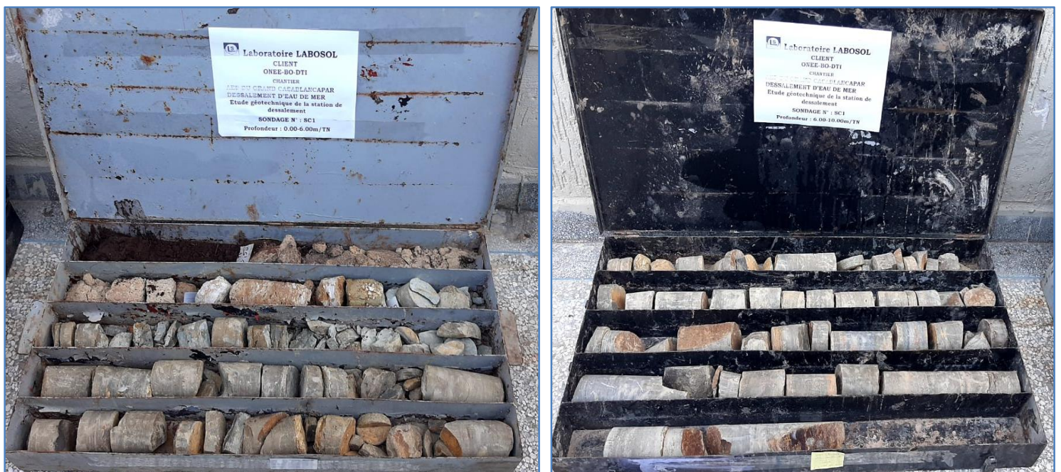
Photo N°8 : Montrant les matériaux extraient du sondage carotté SC1 du 6.00 à 10.00m/TN
