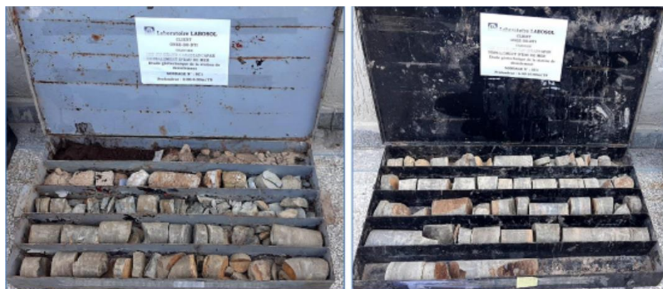
Figura 09: Muestra de material extraído del sondeo mecánico SC1 de 6 a 10 m/TN Fuente. Anejo 2: Secciones litológicas
