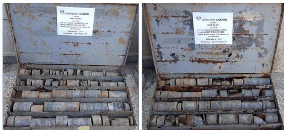
Figura 10: Muestra de material extraído del sondeo mecánico SC2 de 6 a 15 m/TN Fuente. Anejo 2: Secciones litológicas
