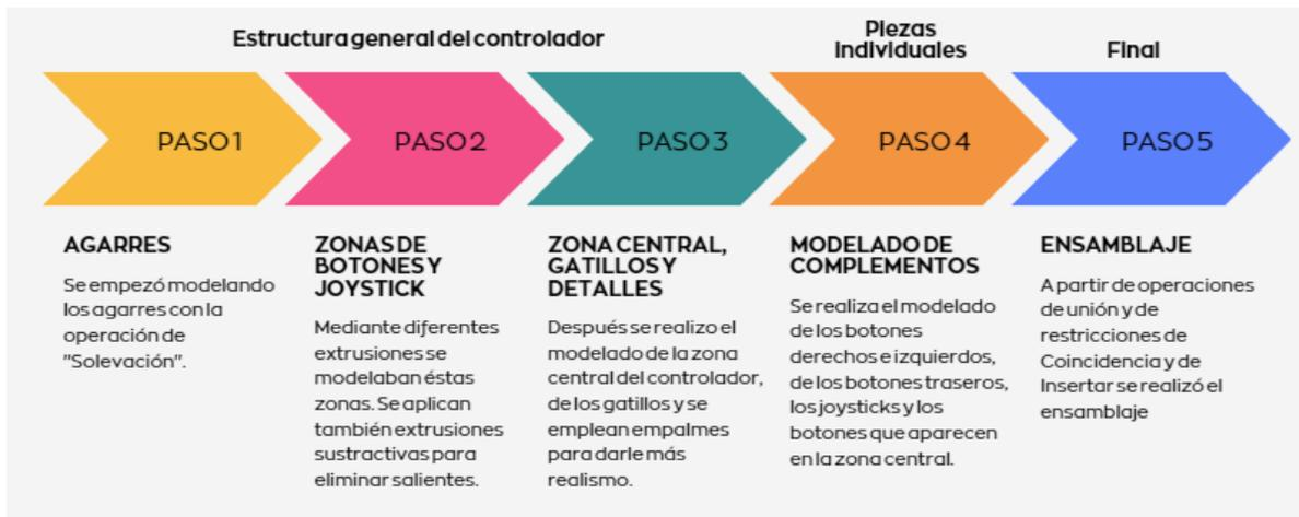
Figura 3.2: Secuencia de modelado para los controladores de la PS1 y PS5
