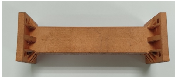
Figura 69. Pieza final de guía de onda de referencia (cara ancha de la guía).
