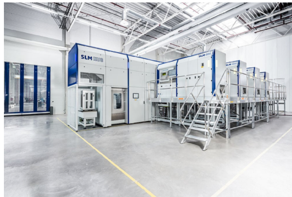
Figura 13. Impresora de técnica de fabricación por sinterización laser de metal directo DMLS [17].
