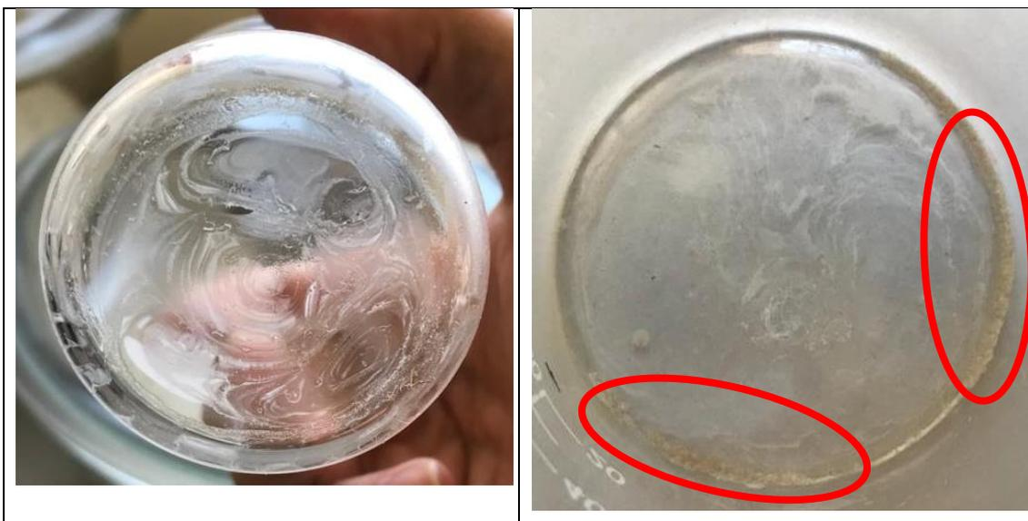
Figura 11. Residuos del ensayo de migración en vasos de precipitado.
