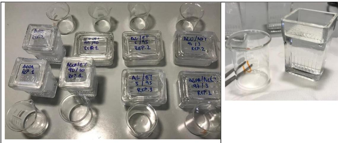
Figura 6. Cubetas Hellendahl con su correspondiente vaso de precipitado.
