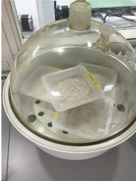
*Figura 2. Muestras de PBS en desecador.*
