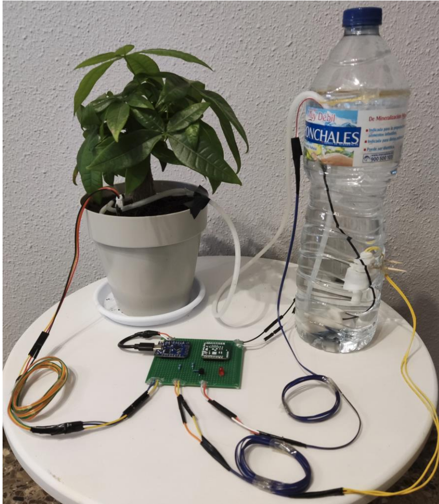
Figura 29. Montaje completo del sistema utilizando una placa perforada.
