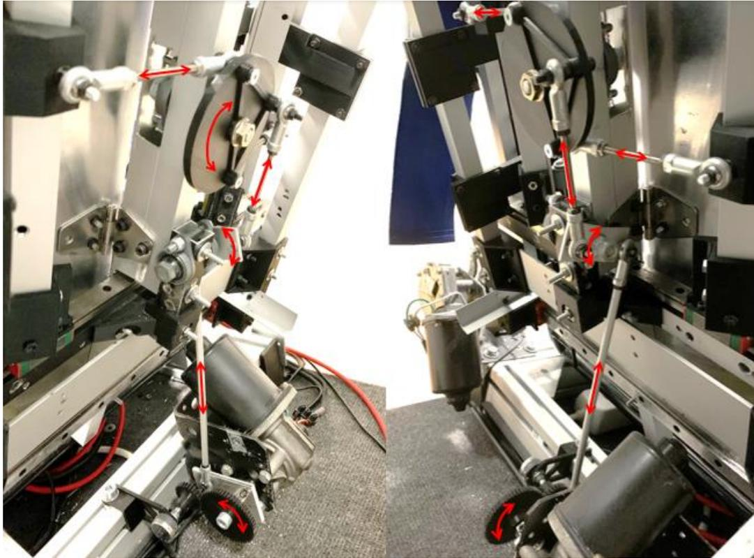
*Ilustración 47. Esquema de movimiento de varillas y distribuidor*
