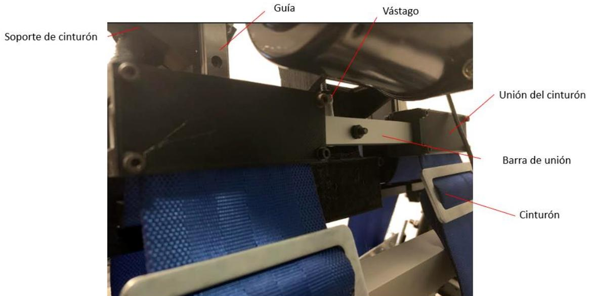
*Ilustración 82. Elementos del sistema de tensión para el cinturón*
