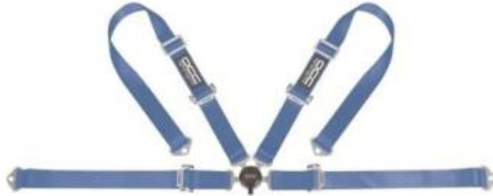
*Ilustración 25. Arnés de cuatro puntos de anclaje (Fuente: amazon.es)*
