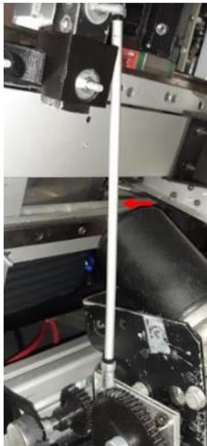
Ilustración 51. Varilla de transmisión de esfuerzos
