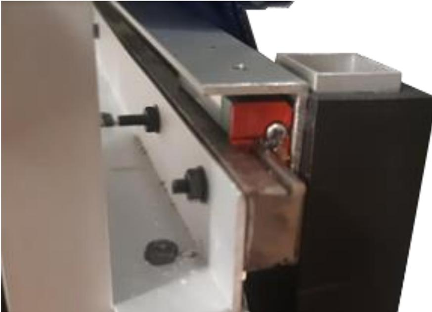
Ilustración 44. Guías para movimiento lateral
