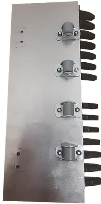
Ilustración 67. Placas de apoyo para movimiento frontal
