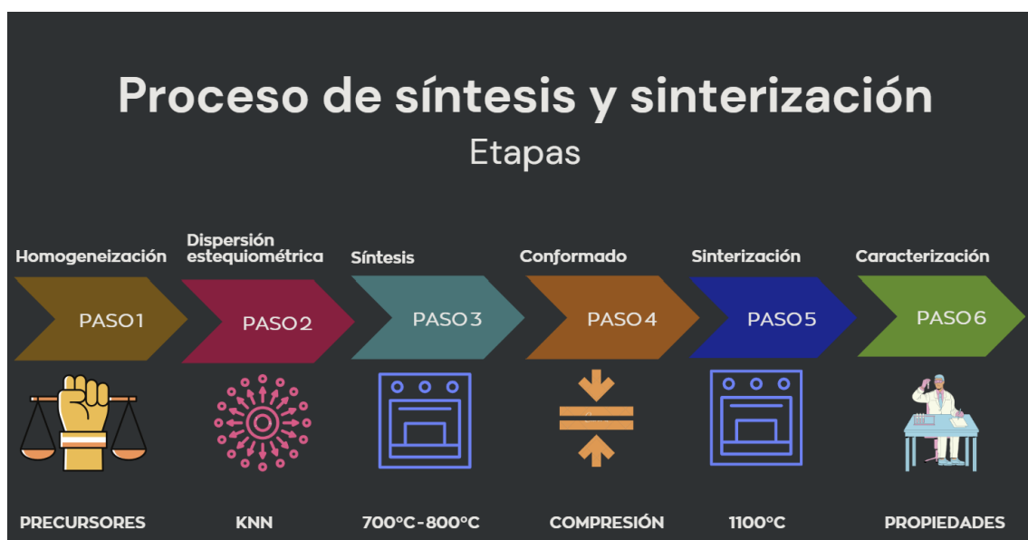
Figura 5. Proceso de síntesis y sinterización.
