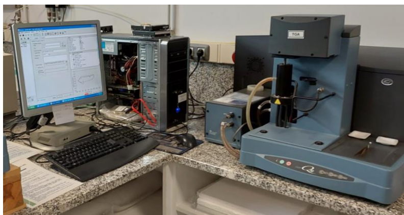
Figura 10. Equipo de caracterización del análisis termogravimétrico, TGA Q50.
