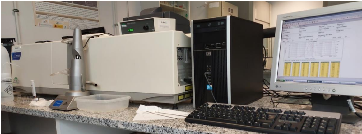
Figura 9. Equipo de caracterización de tamaño de partículas Mastersizer 2000.
