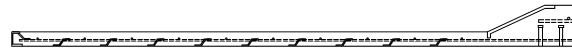
Figura 1.2. Configuración de cercos “Z” en el tablero para asegurar la colaboración de las diferentes partes del tablero. Fuente: Elaboración Propia (AutoCAD)
