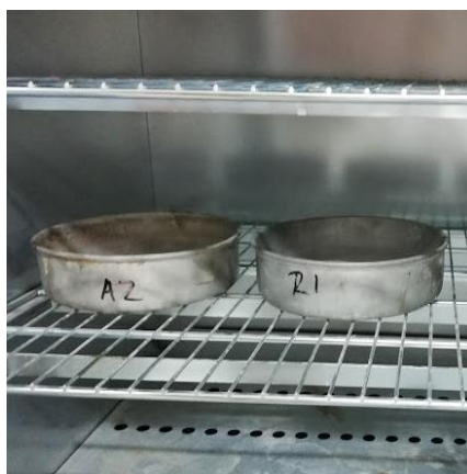
Imagen 4.4. “Secado al horno para determinación de capacidad de absorción”
