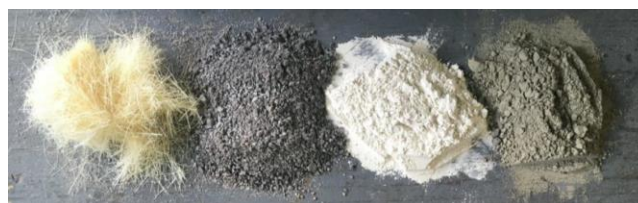
Imagen 5.6. Materiales constitutivos del mortero de recubrimiento de los muros A, B y C. (De izquierda a derecha: fibra de yute, arena, cal y cemento.)
