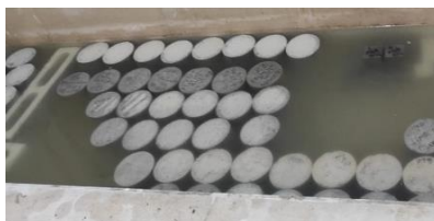
Imagen 4.16. “Proceso de curado de los especímenes”
