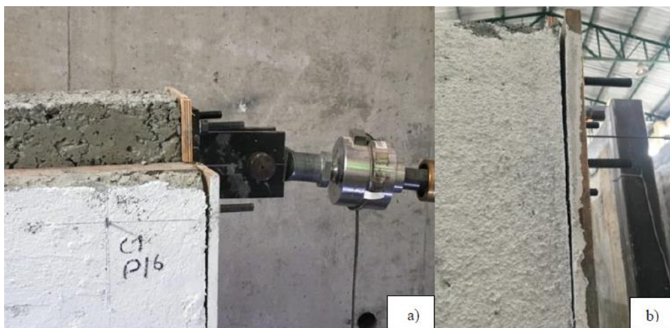
Imagen 5.15. Separación de los tableros de confinamiento de madera laminada. a) Extremo superior derecho. b) Extremos superior izquierdo.
