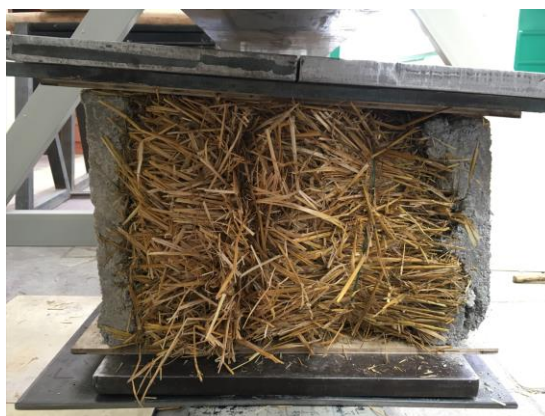
Imagen 3.45. “Deformaciones distintas en cara posterior y delantera del fardo”
