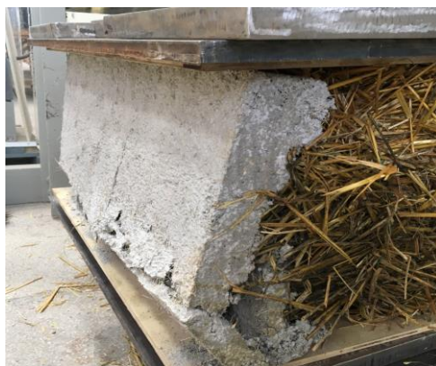
Imagen 3.44. “Fardo de Paja revocado tras ensayo de compresión”
