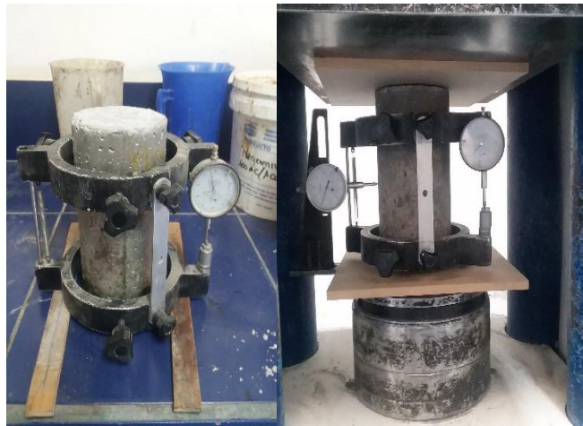
Imagen 4.27. “Ensayo de módulo estático de elasticidad y coeficiente de Poisson”
