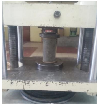
Imagen 4.17. “Ensayo de compresión simple”
