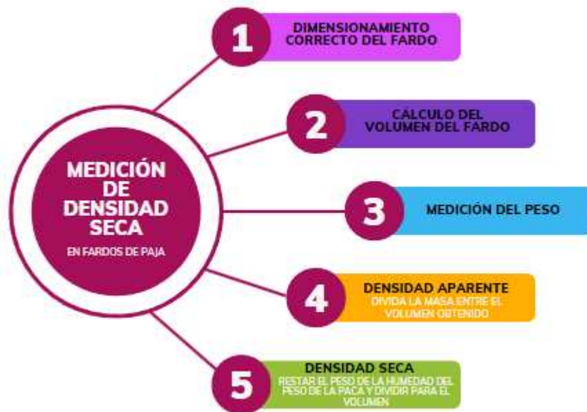
Imagen 3.18. “Pasos para la medición de la densidad seca”
