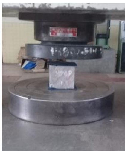
Imagen 4.13. “Ensayo a Compresión axial de los cubos de mortero”
