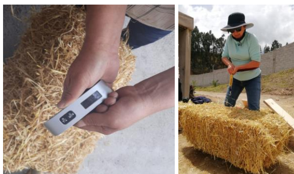
Imagen 3.17. “Medición del peso del fardo de paja”
