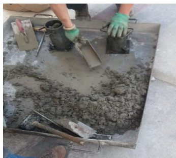
Imagen 4.15. “Llenado de los cilindros de mortero”
