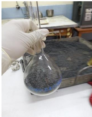
Imagen 4.3. “Peso específico de la arena”
