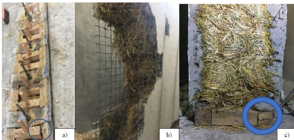
Imagen 5.16. Imagen 1.1. a) Dentro del círculo se muestra la separación de travesaños de la escalerilla inferior en los extremos. b) Malla de refuerzo intacta en la parte central del cuerpo del muro. c) Dentro del círculo se evidencia la falla a cortante en uno de los travesaños de la escalerilla del muro A.
