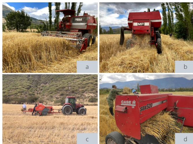
Imagen 3.6. a. “Cosecha de trigo” b. “Tendido de paja después de la cosecha” c. “Máquina enfardadora” d. “Cilindro recogedor de paja”
