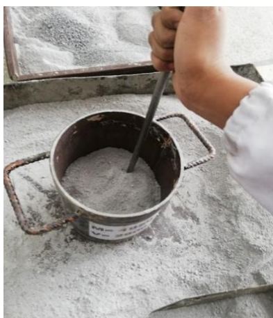
Imagen 4.2. “Peso específico de la arena”
