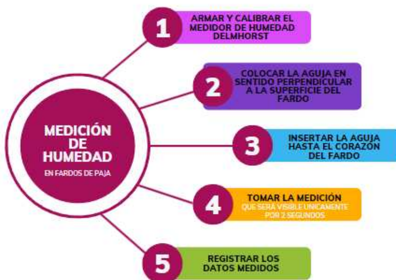
Imagen 3.15. “Pasos para la medición de la humedad en fardos de paja”
