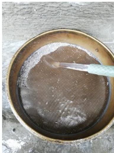
Imagen 4.8. “Ensayo de determinación de residuo mediante lavado”
