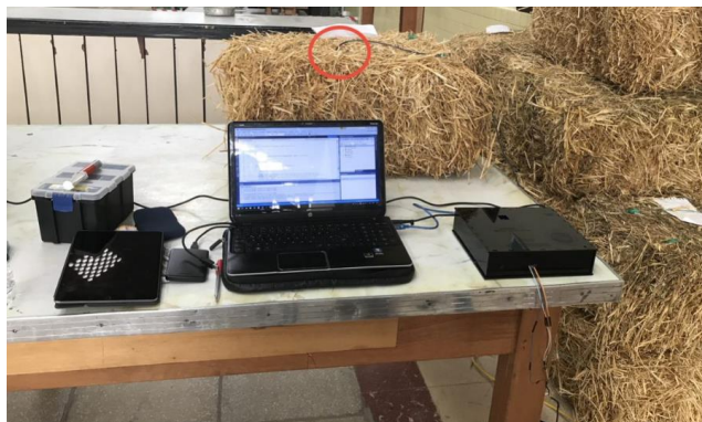
Imagen 3.29. Ensayo de aguja térmica en laboratorios Universidad Central del Ecuador, 2020
