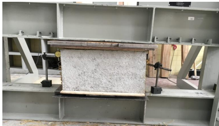
Imagen 3.43. “Compresión en fardos, laboratorio de materiales UCE”
