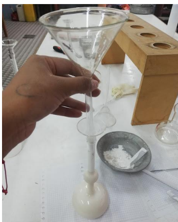
Imagen 4.7. “Ensayo de densidad de la cal con el frasco Le Chatelier”
