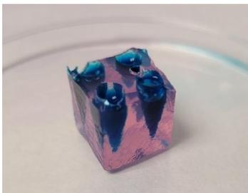
**Figura 8.** Soporte de cultivo/hidrogel de agarosa (1,5% p/v) cúbico con 4 pocillos de forma cónica.
